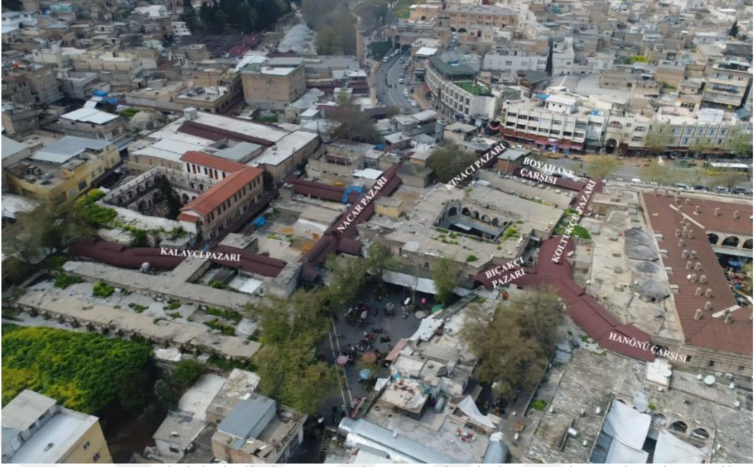
Şekil 3. 206 Demir iskeletli ahşap membran üzerine kahverengi şingil malzeme ile örtülü çarşı ve pazarlar (Orijinal, 2019)
