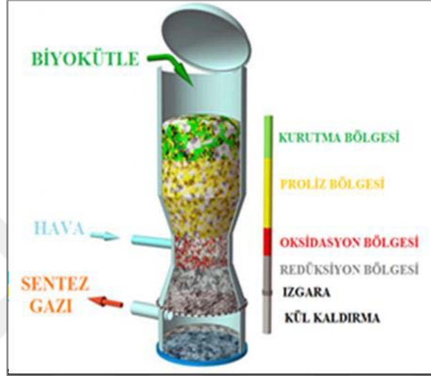
Şekil 2.13 Gazlaştırmanın reaktör içerisindeki aşamaları
