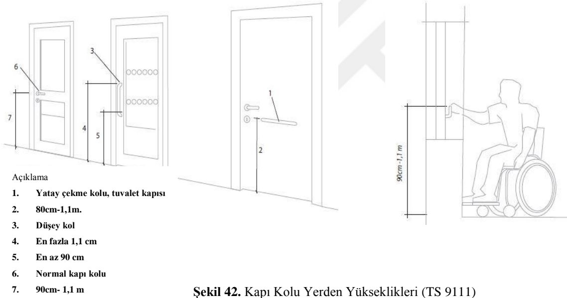
Şekil 42. Kapı Kolu Yerden Yükseklikleri (TS 9111)
