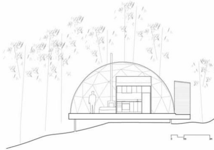
Şekil 3.73: Kubbe yapısının kesiti (Bourgeois /Lechasseur Architects, 2018)
