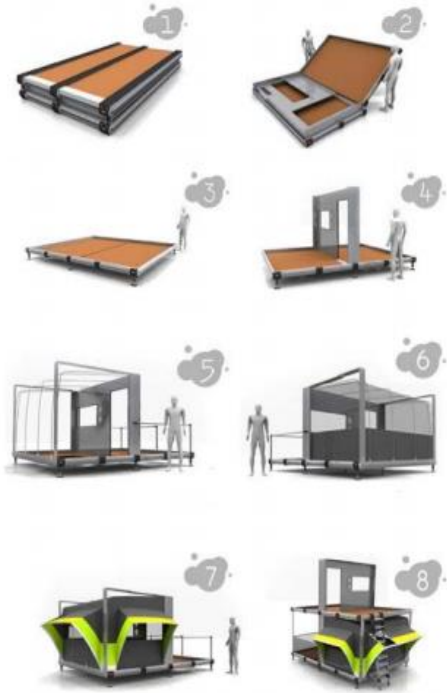
Şekil 3.93: Uber barınağın birleşim şeması (Kaynak: Smith'den [2008]aktaran Beyatlı, 2010;44)
