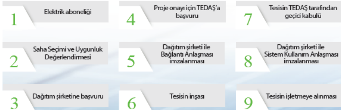
Şekil 3.10. Değerlendirme ve kurulum sıralaması şeması
