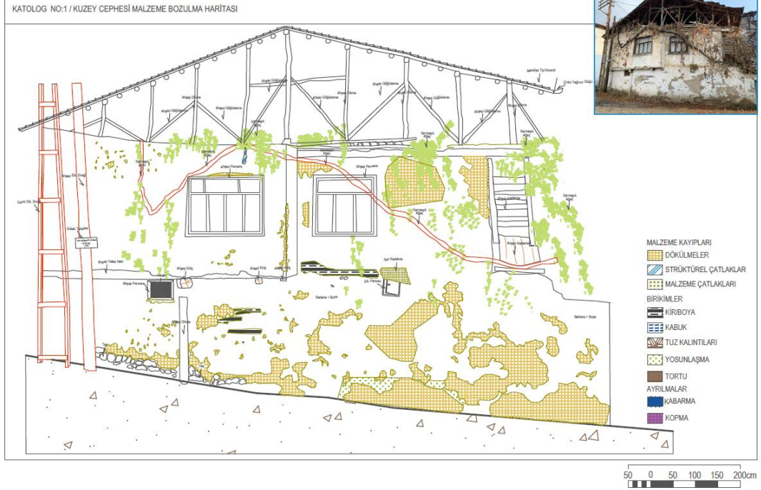
Şekil 4.2: 238 ada 1 parsel kuzey cephesi malzeme bozulma haritası
