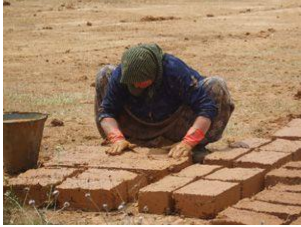
Şekil 2.22. Üst tabakaya kaymak uygulaması ve kalıptan çıkarma ( https://lh3.googleusercontent.com/proxy/W7oO27uBpoNMDV24AyskezU9NLbFV4cbVo2FNkTcX9Kz4qp1R9U9PAu6FctippE8yo76n0m3bk1XFic5m6-T-_4 )
