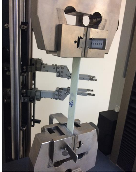
Şekil 3.25 : Cam elyaf takviyeli ve karbon elyaf takviyeli NKS/epoksi nanokompozit numunesi düzlem içi kayma testi
