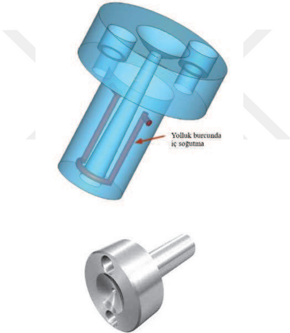
Şekil 2.2: Yolluk ve giriş gösterimi [5]
