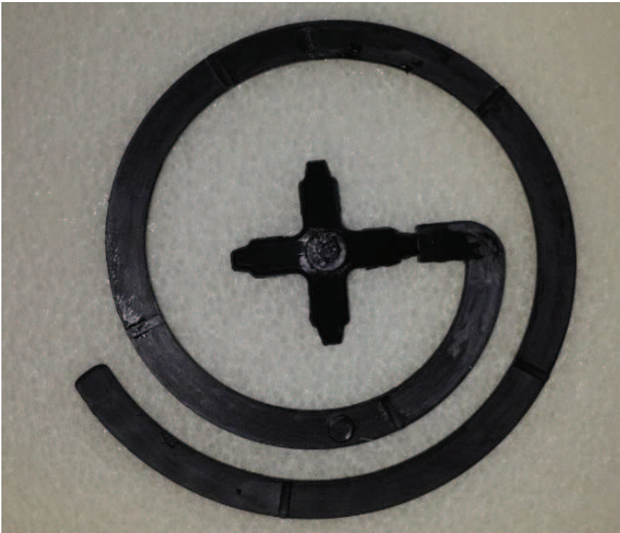
Şekil 4.5: 50 mm aralıklarla bölünmüş parçanın gösterimi
