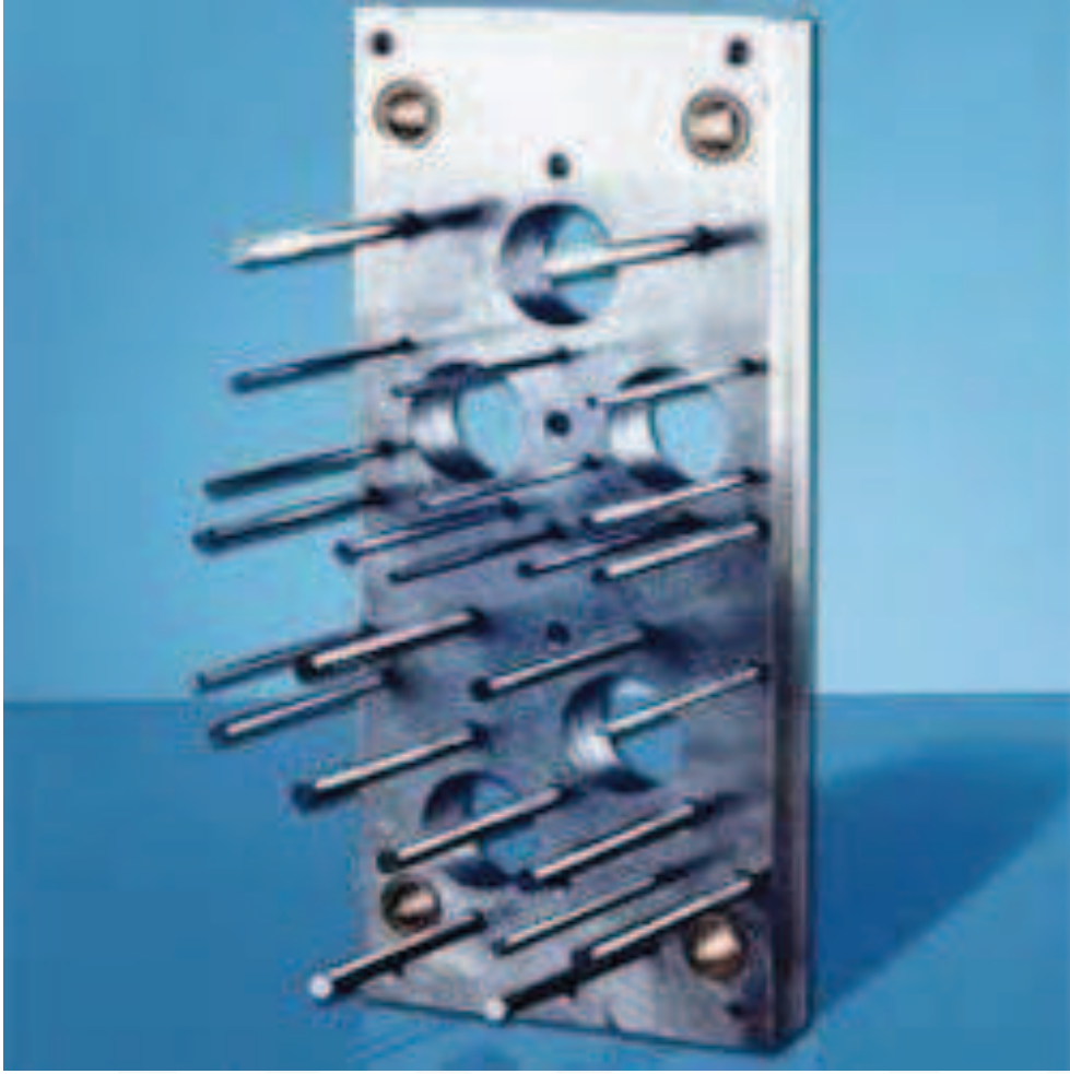
Şekil 2.5: Çıkarıcı sistem bileşenleri[7]
