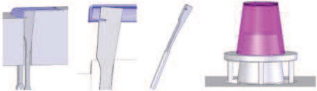
Şekil 2.10: Eğilebilir çıkarıcı ve sıyırıcı plaka
