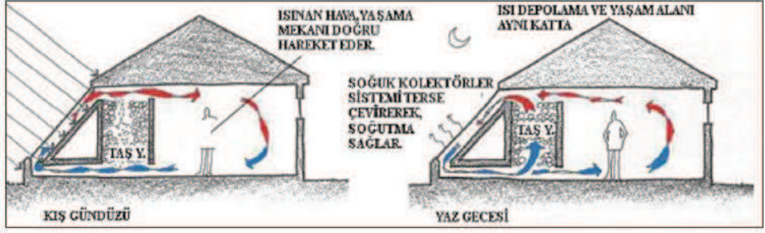
Şekil 3.6: Taş yataklamanın güneş kolektörleri ile birlikte çalışma prensibi [6].
