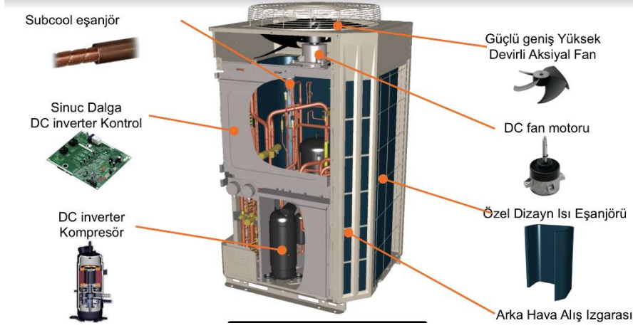
Şekil 2.5: Bir VRF dış ünitesinin yapısı [12].
