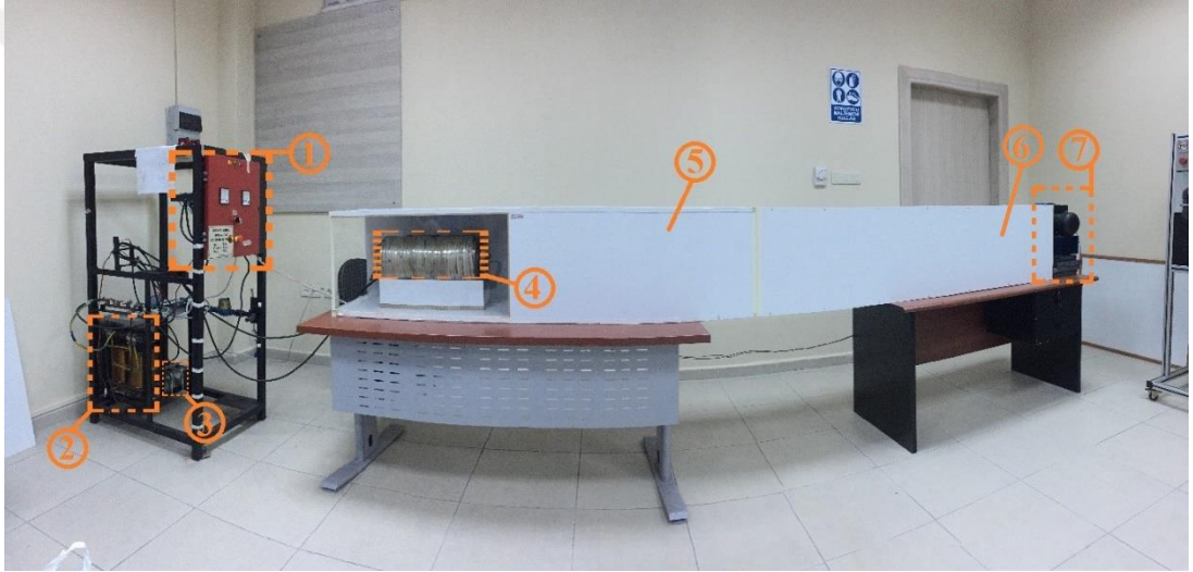
Şekil 6.1 : İndüksiyonlu gaz ısıtıcısı deney düzeneği.
