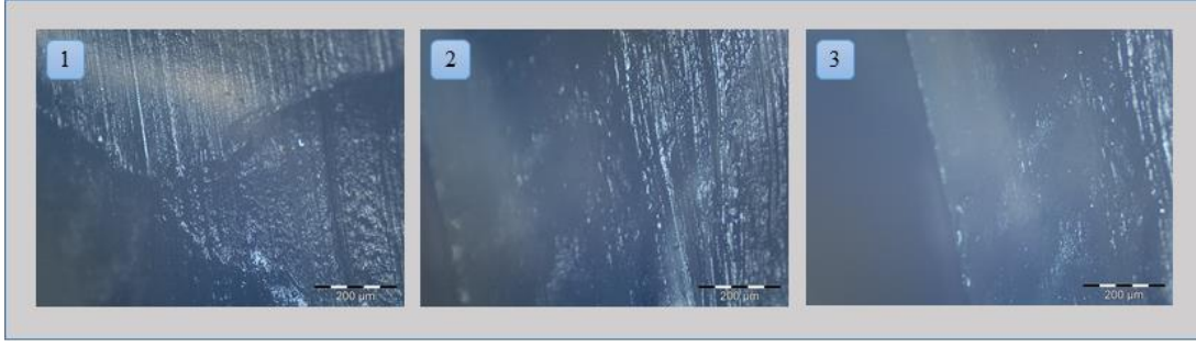
Şekil 5.9 : Polipropilen malzemelerin zikzak tel ile 90° açıyla kaynaklı birleştirmelerinin optik mikroskop görüntüleri
