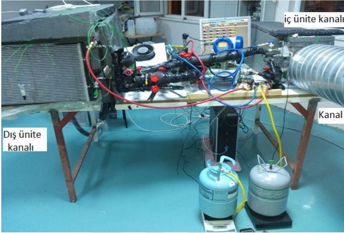
Şekil 3.4 : Deneysel ısı pompası sisteminin görünümü.
