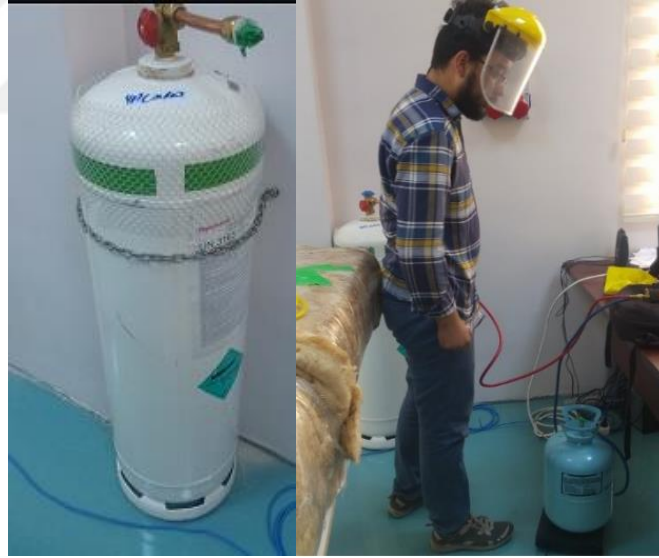
Şekil 3.13 : R1234ze(E)'nin sisteme şarj edilmesi.
