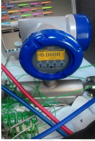
Şekil 3.5 : Deney sisteminde kullanılan Coriolis tipi kütleli debimetre ve flanş bağlantıları.
