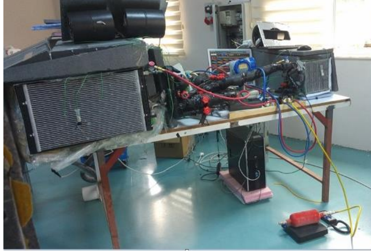
Şekil 3.12 : R152a'nın sisteme şarj edilmesi.
