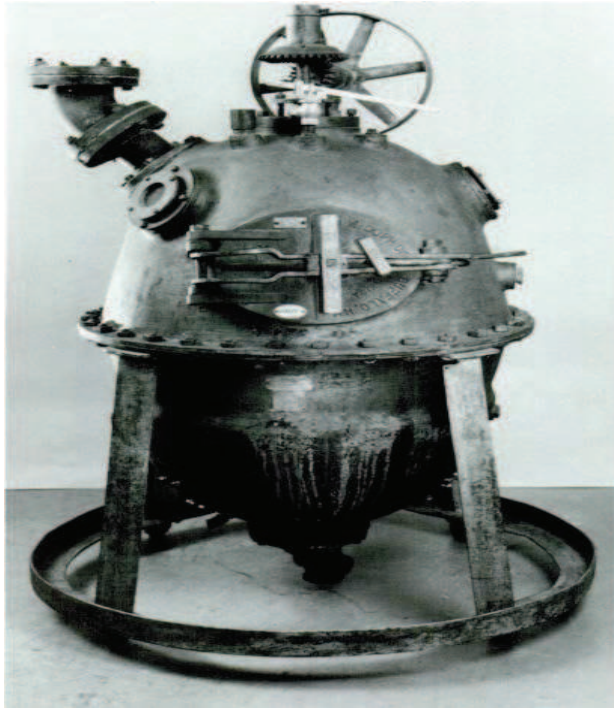
Şekil 2.1 Henri Baekeland tarafından, bakalit üretimi için kullanılan ilk reaktör[13].
