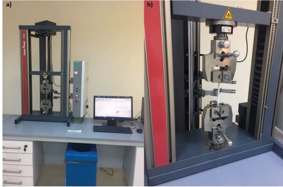
Şekil 3.4 : a) Çekme testi cihazı b) Test işlemi sırasında numune ve çekme çeneleri.
