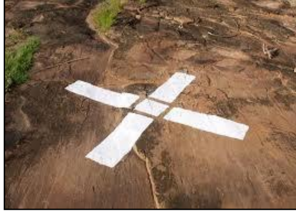
Şekil 3.10: Hava fotogrametrisindeki yer kontrol nokta tesisleri [36]
