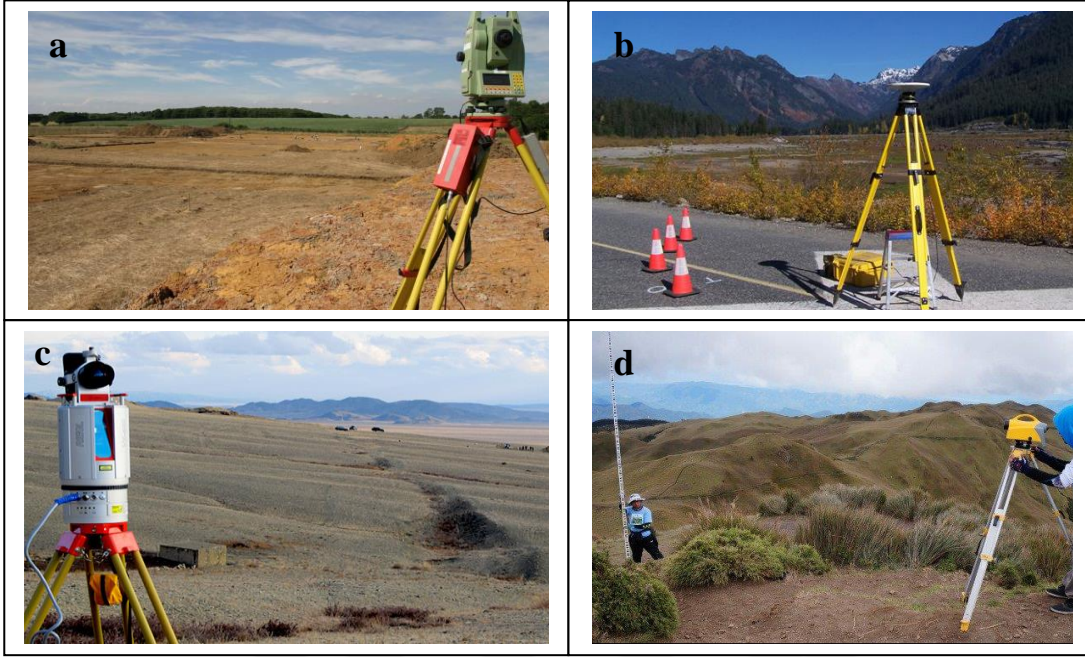
Şekil 3.6. a,b,c ve d: Elektronik Total Station, GPS ya da GNSS, yersel Lidar sistemleri ve Nivo ile yapılan yersel ölçme çalışmaları [28,29,30,31]
