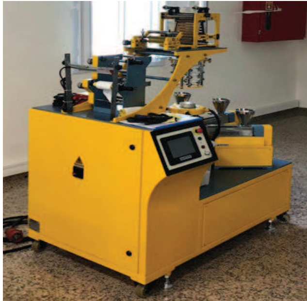
Şekil 2.7 Prototip şişirme film (blown film) ekstrüzyonu
