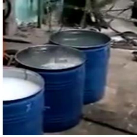
c) %10'luk polimer karışımına numunelerin daldırılması
