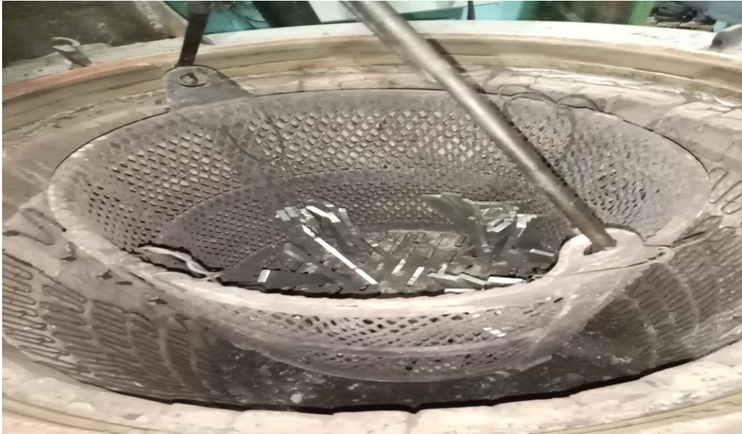
Şekil 4.7 Malzemelerin ısıtılma fırınına sepet içerisinde yerleştirilmesi
