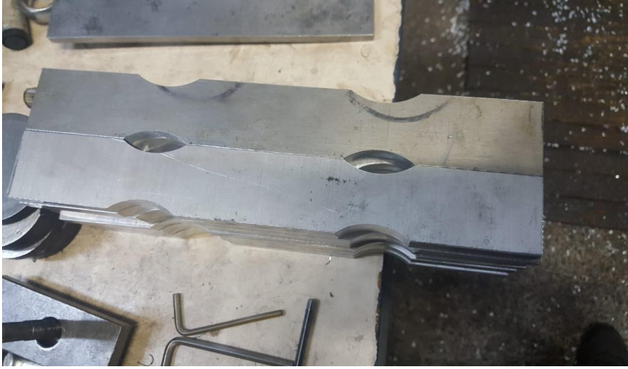
d) Çekme numunelerinin tutma kısımlarının işlenmesi
