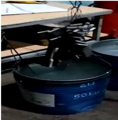
a) Su ortamına numunelerin daldırılması
