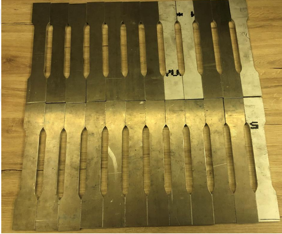
a) AA7075 alaşımına ait çekme test numuneleri
