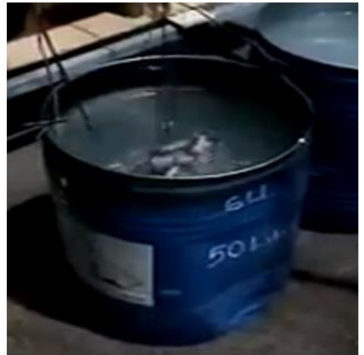
a) Su ortamına numunelerin daldırılması
