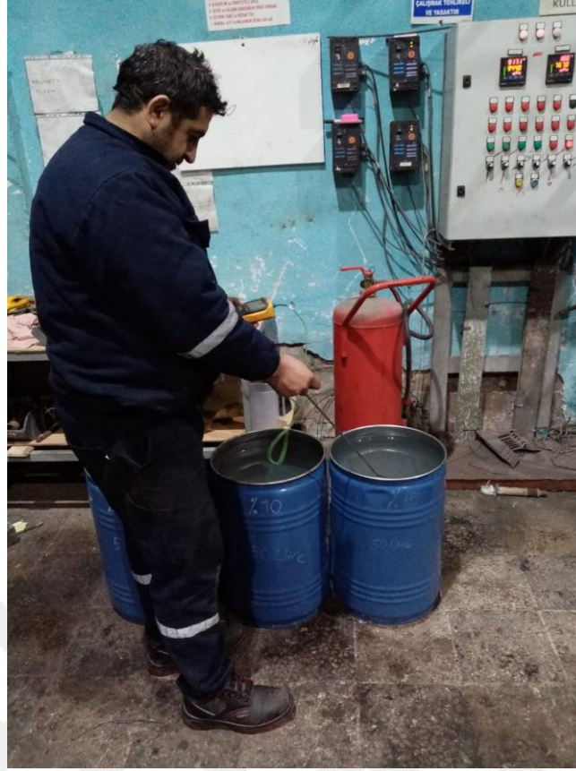
Şekil 4.12 %15'lik polimer çözeltisinin su verme öncesi sıcaklık kontrolü
