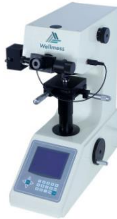
Şekil 4.20 Vicker Sertlik Ölçüm Cihazı
