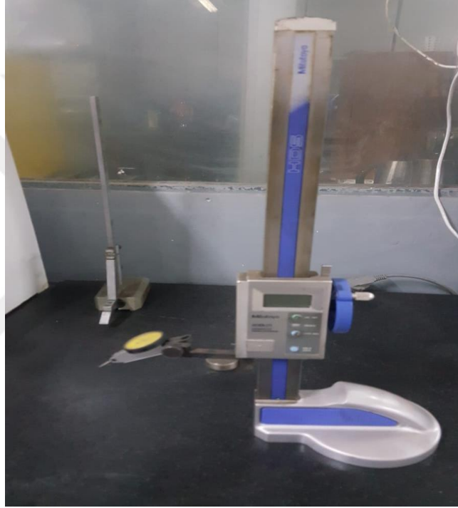
Şekil 4.22 Ölçüm pleyti ve mitutoyo kompratöre ait resim
