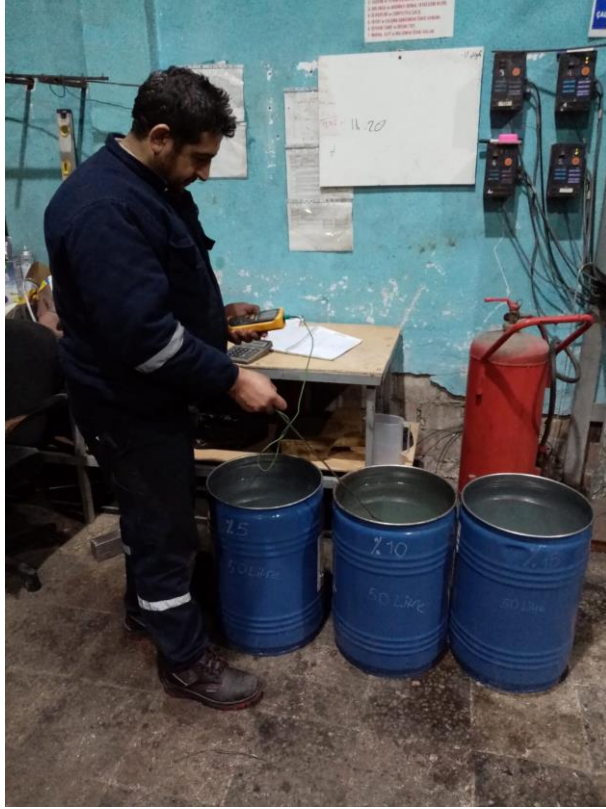
Şekil 4.11 %10'luk polimer çözeltisinin su verme öncesi sıcaklık kontrolü
