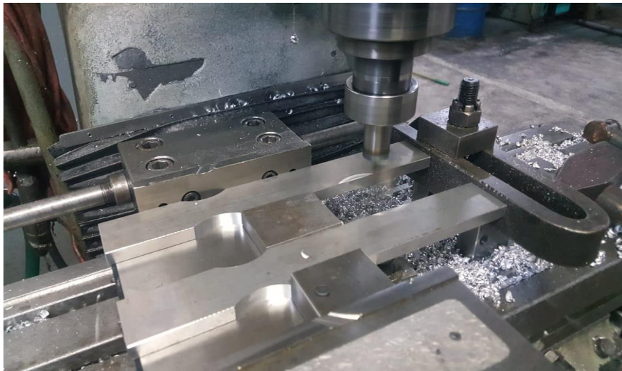
c) Çekme numune geometrisinin frezelenmesi
