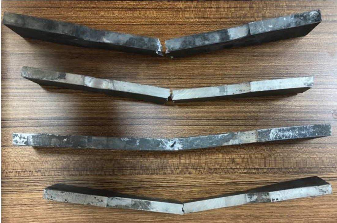
Őekil 5.5 AA2024, AA6082, AA7075 alařımlarının eėme testlerinde kırılma gerekleřen test numunelerinin grnts
