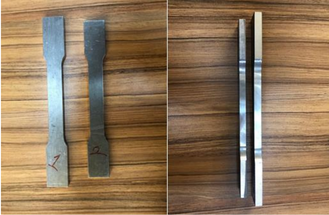
c) AA2024 ve AA7075 alařımlarına ait çekme test numunelerinin boyutsal farkı
