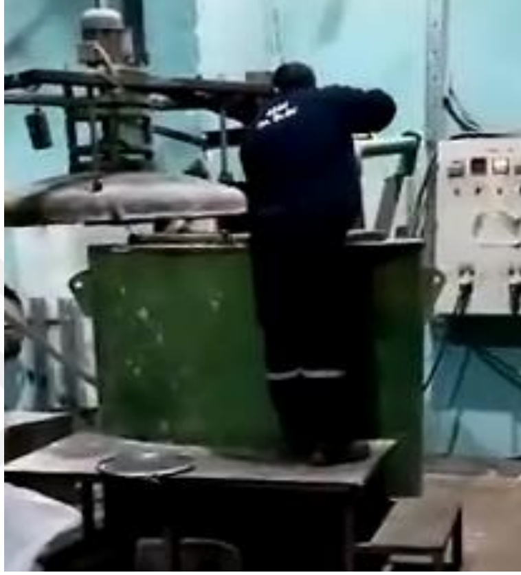
Şekil 4.14 Isıtma fırınından numunelerin alınması
