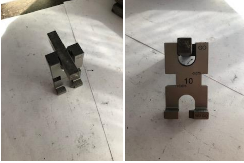
Şekil 4.19 Geçer geçmez masterlarla darbe numuneleri çentik kontrolü
