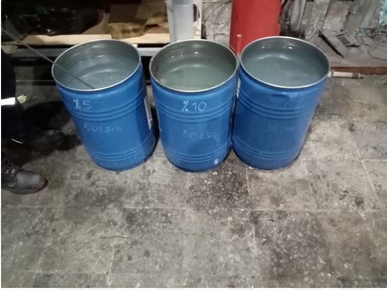
Şekil 4.10 %5'lik polimer çözeltisinin su verme öncesi sıcaklık kontrolü
