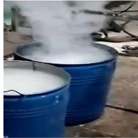
d) %15'lik polimer karışımına numunelerin daldırılması
