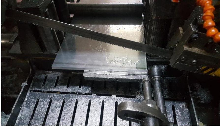
a) Levhaların testerede kesilmesi
