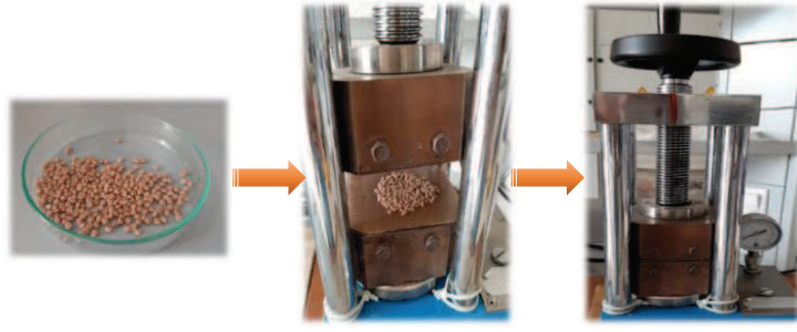
Şekil 3.4 Kompozit filmlerin hazırlanması
