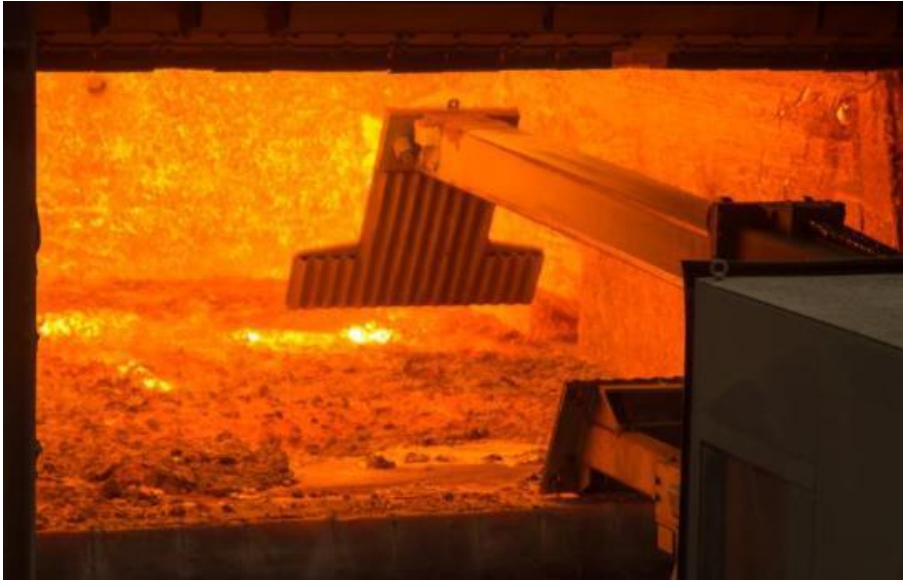
Şekil 3.5 Drossun fırından çekilme görüntüsü [45].
