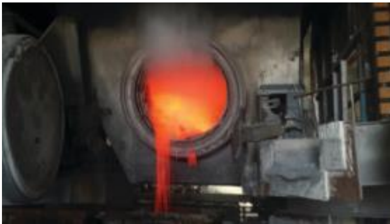
Şekil 2.12 Devrilebilir döner fırından dross alma [1].
