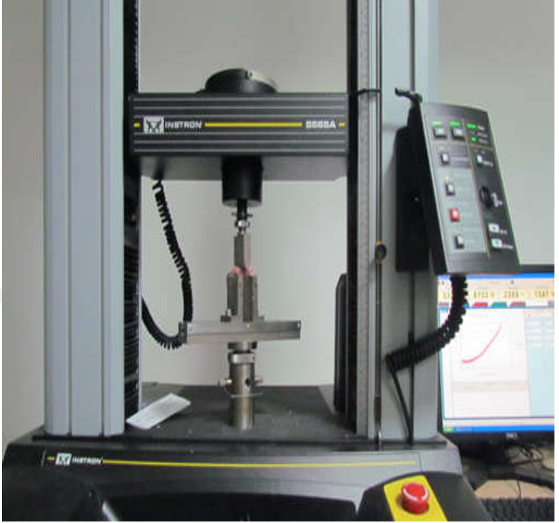
Fotoğraf 3.16. Femurlar Instron 5565-A cihazında (Instron Company®, Massachusetts, ABD) biyomekanik olarak incelendi.
