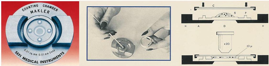
Şekil 5: Makler Sperm Sayma Kamerası (30)
