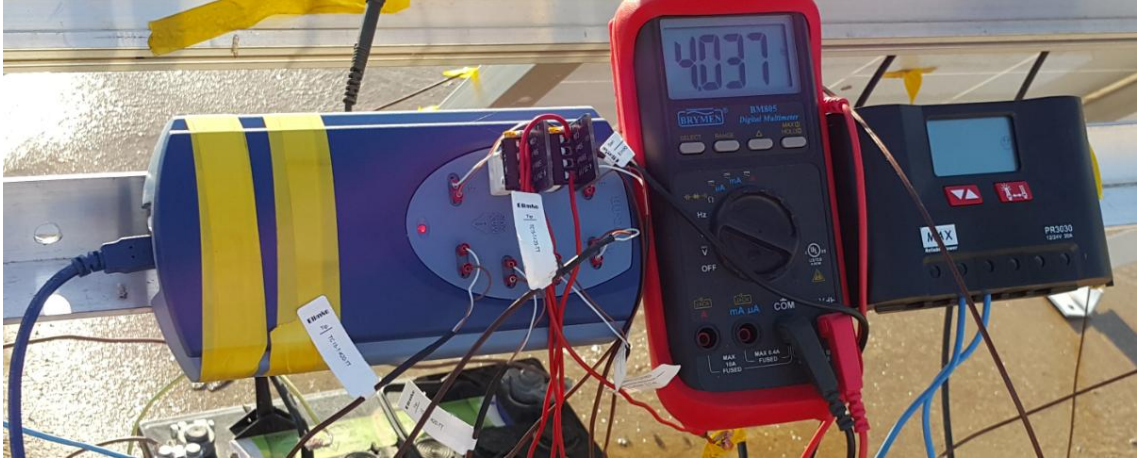
Şekil E2.5 Data Logger ve Multimetrelerden ölçümlerin eş zamanlı alınması
