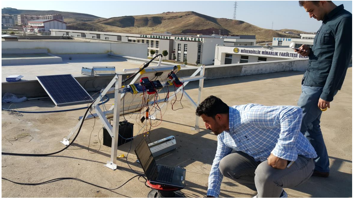
Şekil E2.6 Ölçülen gerçek zamanlı verilerin bilgisayara aktarılması
