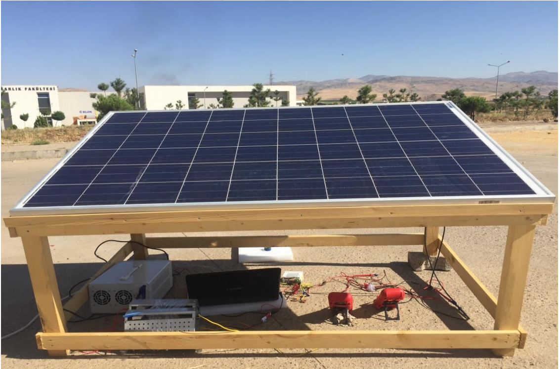
Şekil E5.2. Sabit panel bağlantılarının yapılması
