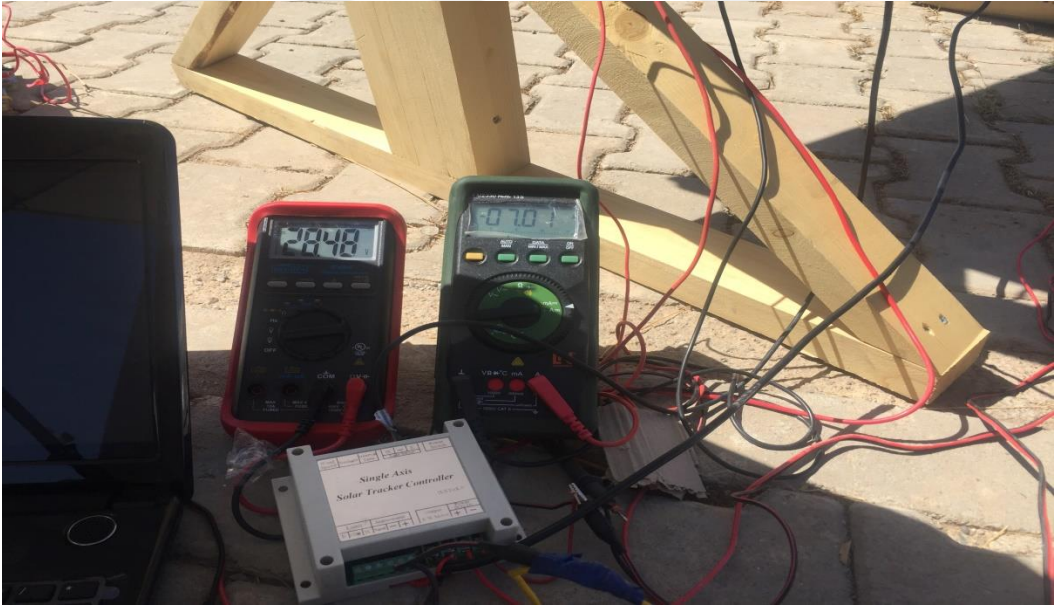
Şekil E5.4. Bilgisayar ve multimetrelerden eş zamanlı ölçüm alınması
