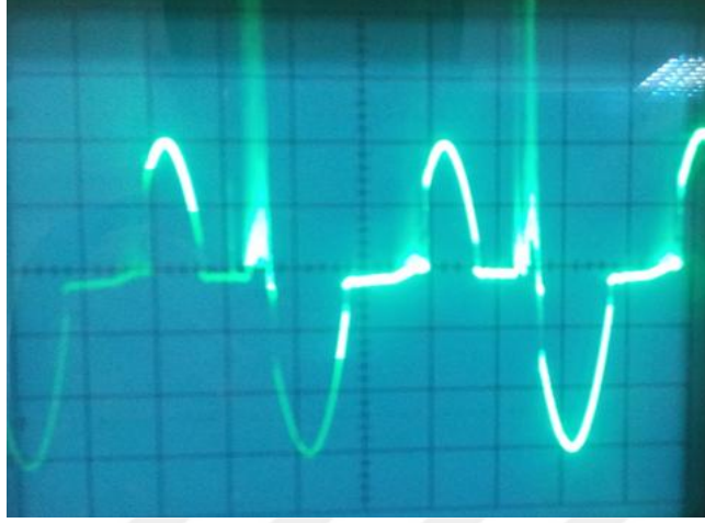
Şekil 4.2. İğne-Düzlem elektrot sisteminin 500 Hz frekansındaki pozitif koronaya ait akım osilasyonları görüntüsü
