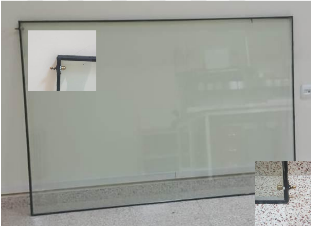
Şekil 3.2: Saydam cam malzemedен yapılmış olan gaz deposu görüntüsü
