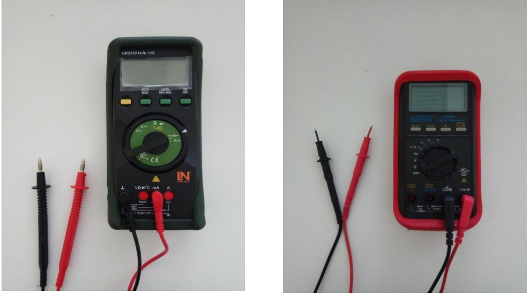
Şekil 3.3: Deney sisteminde kullanılan dijital tip AVOMETRE'lerin görüntüleri
