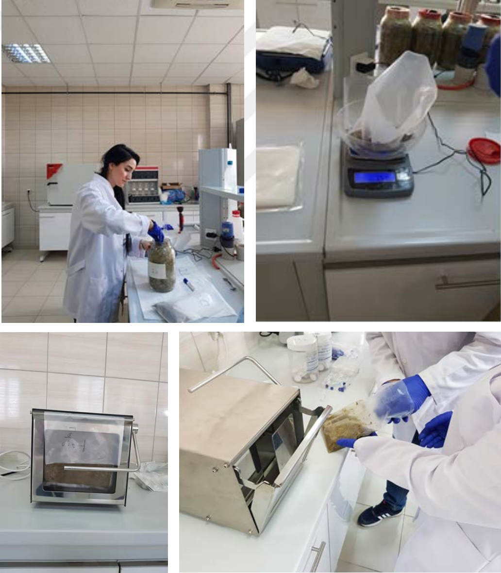
Şekil 3.5. LA, AA ve BA analizleri için silaj örneğinin polietilen poşetlere konulması ve ekstraksiyon işlemi
