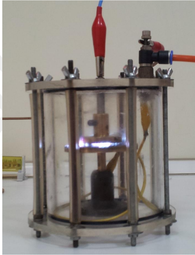
Şekil 4.13: f=300 \text{ Hz} frekansında oluşturulan DBB görüntüsü
