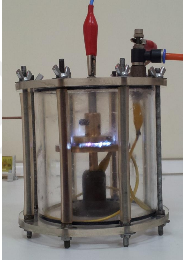
Şekil 4.19: f=500 \text{ Hz} frekansında oluşturulan DBB görüntüsü
