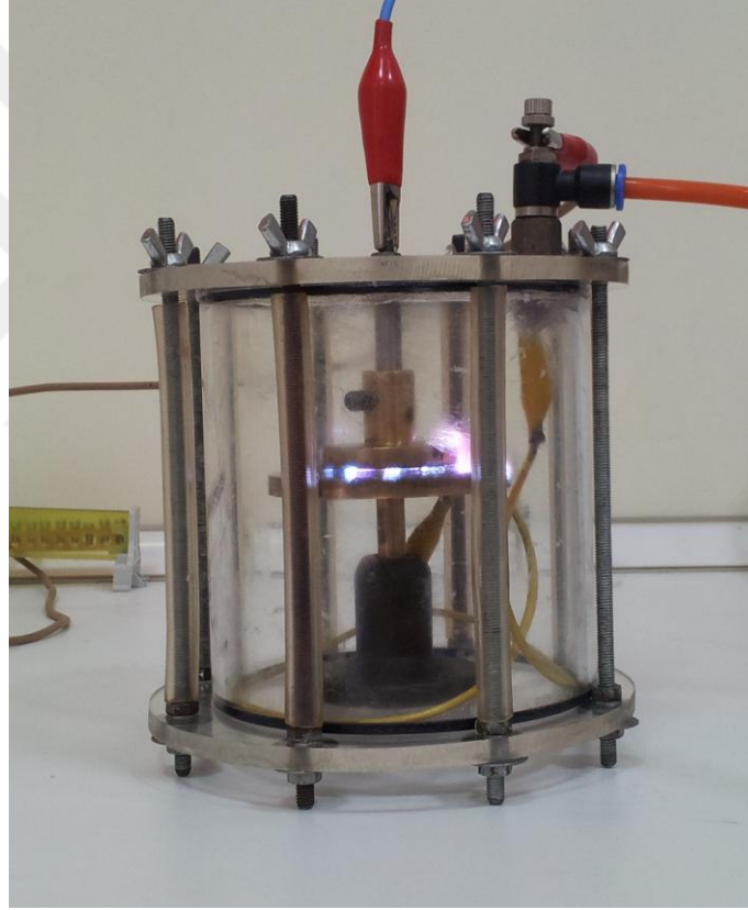
Şekil 4.10: f=200 Hz frekansında oluşturulan DBB görüntüsü
