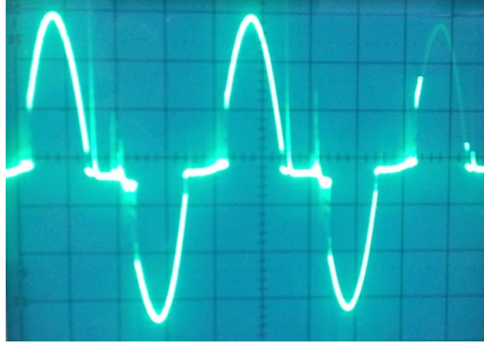
Şekil 4.2: f=50\text{ Hz} frekansındaki DBB'ye ait akım osilasyonu görüntüsü
