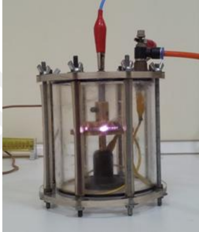
Şekil 4.7: f=150 \text{ Hz} frekansında oluşturulan DBB görüntüsü
