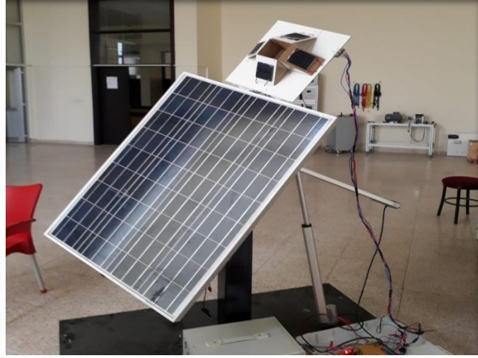
Şekil 5.4. Solar göz sensör düzeneğinin FV panel üzerine yerleştirilmesi
