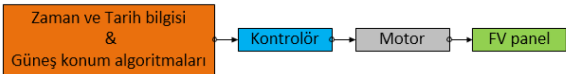
Şekil 4.3. Açık çevrim kontrol yapısının genel gösterimi
