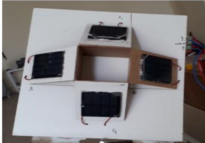
Şekil 4.7. Küçük güneş pillerinden oluşturulmuş solar göz sensör düzeneği
