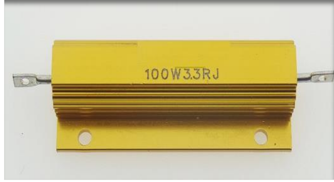
Şekil 5.2. Alüminyum kaplamalı 100 W 3.3 \Omega değerindeki yük direnci
