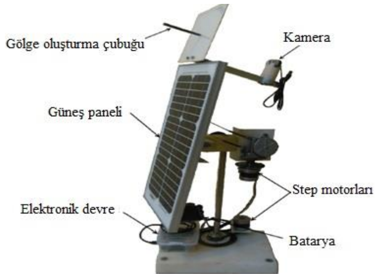
Şekil 2.2. Görüntü işleme tabanlı güneş takip sisteminin elektromekanik yapısı
