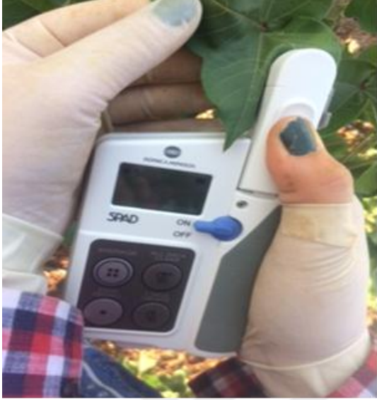
Şekil.3. SPAD 502 Klorofil Ölçer
