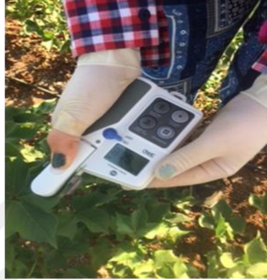
Şekil.4. SPAD Aleti ile klorofil ölçümü
