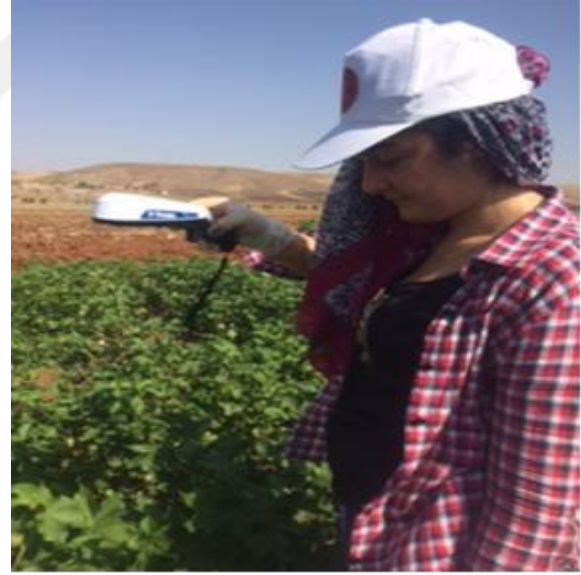
Şekil.6. GreenSeeker aleti ile NDVI okumaları
