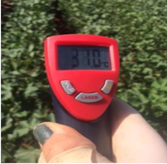
Şekil.5. Kanopi sıcaklığı ölçümü
