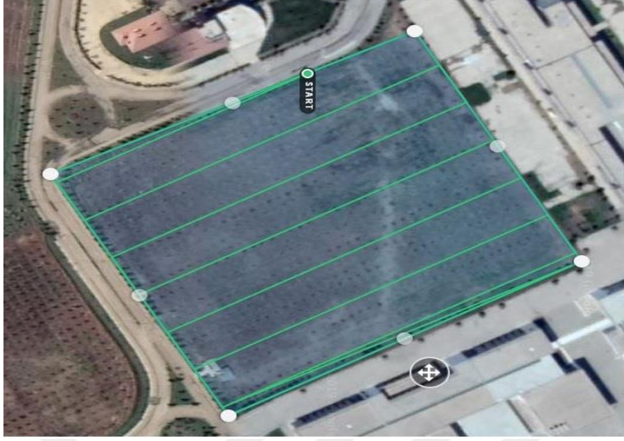
Şekil 3. 3. Drone Deploy programında Bölge-1 uçuş planlaması
