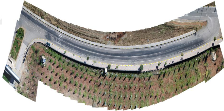
Şekil 3. 9. Bölge-3 için Adobe Photoshop Uygulamasının Photomerge Özelliği Kullanılarak Üretilmiş Nihai Görüntüsü
