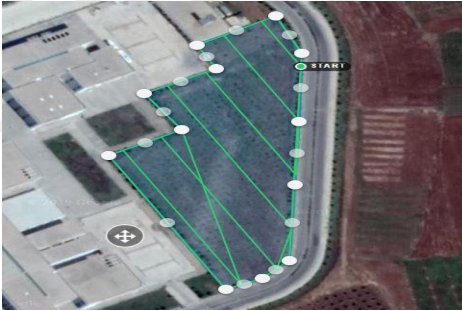
Şekil 3. 6. Drone Deploy programında Bölge-4 uçuş planlaması
