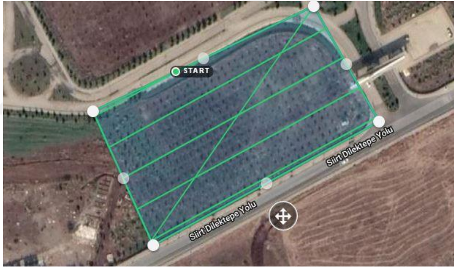
Şekil 3. 4. Drone Deploy programında Bölge-2 uçuş planlaması
