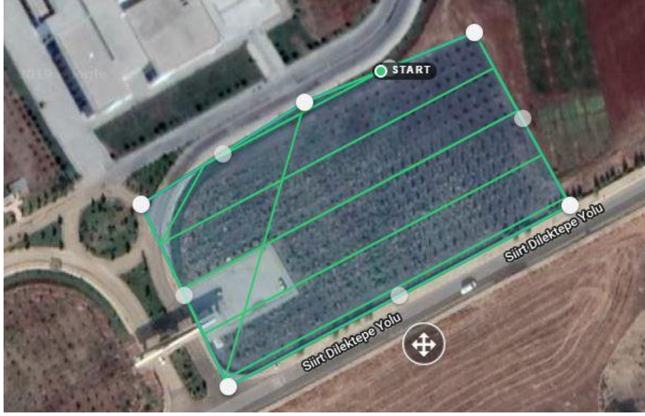
Şekil 3. 5. Drone Deploy programında Bölge-3 uçuş planlaması
