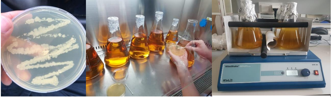
Şekil 3.2. Sıvı besi yerine aktarılan bakterilerin yatay çalkalayıcıda inkübe edilmesi
