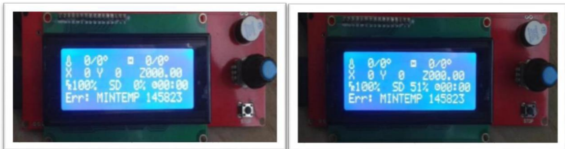
(a) Yeniden başlama noktasına sıçramadan önce hazırlık komutlarının uygulanması esnasındaki ana ekran.
