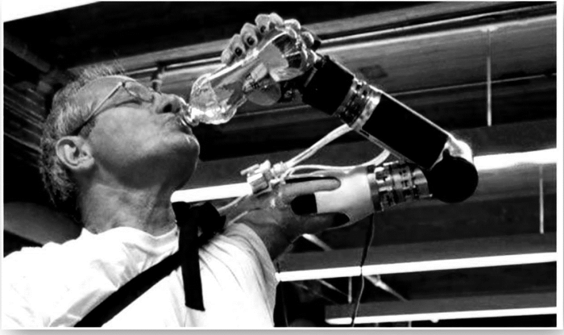
Şekil 1. 4. Üç boyutlu yazıcı ile üretimi yapılan suni el
