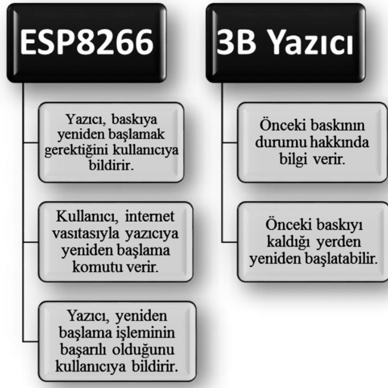
Şekil 3. 2. 3B yazıcı üzerindeki ESP kartına göre önerilen sistemin işlevi
