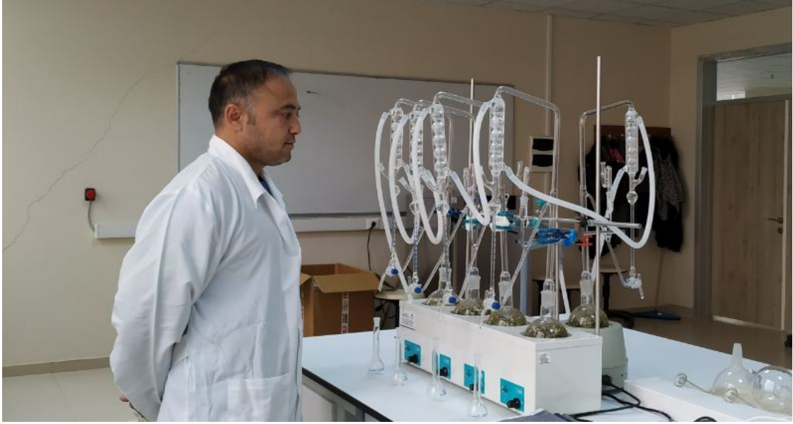
Şekil 4.1. Clevenger aparatında uçucu yağ çıkarma işleminden bir görünüm.
