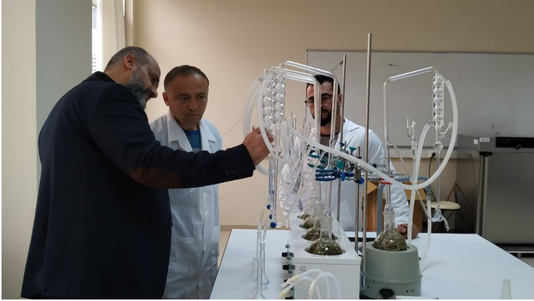
Şekil 3.9. Clevenger aparatında uçucu yağ çıkarma işleminden bir görüntü.
