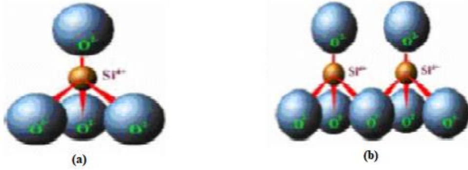
Şekil 2.9. a) Tetrahedral bir hücre (Tetrahedron), b) Tetrahedral tabaka
