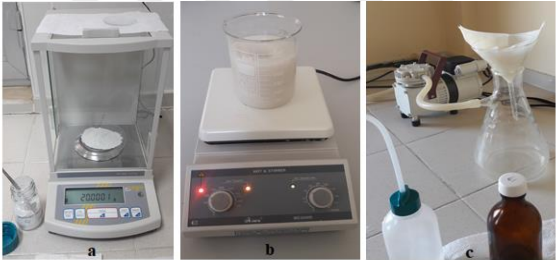
Şekil 3.1. Killerin asitlerle modifiye edilmesi: a. Tartma, b. Karıştırma, c. Süzme
