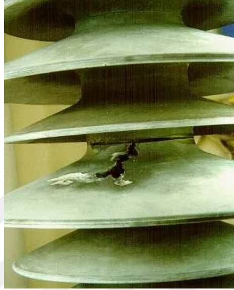
Şekil 1.14. Delinmeye uğramış izolator görüntüsü
