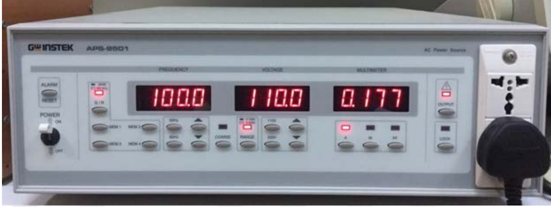
Şekil 3.4. Çeşitli frekanslarda ayarlı çıkış gerilimi verebilen AC güç kaynağı görüntüsü
