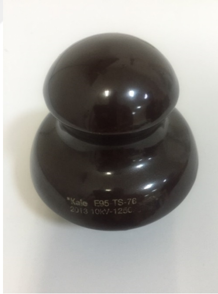
Şekil 3.1. Deneysel sistemde kullanılan izolatör görüntüsü
