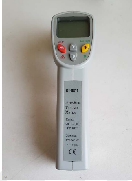
Şekil 3.6. Lazerli IR temassız sıcaklık ölçer görüntüsü
