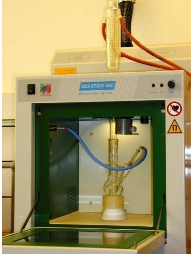
Şekil 49. Atmosferik şartlara göre üretilmiş çoklu-mod mikrodalga cihazı
