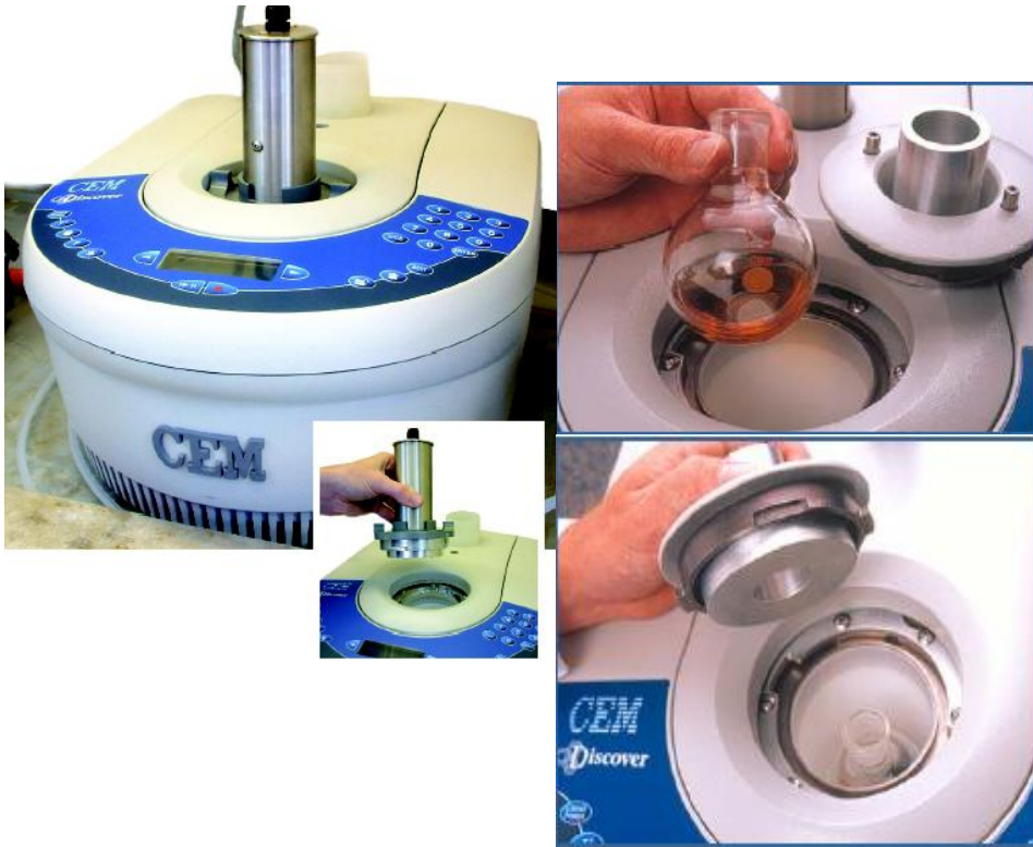
Şekil 47. Atmosferik şartlar ve kapalı basınç şartlarına göre sentez amaçlı üretilen bir tek-mod mikrodalga cihazı
