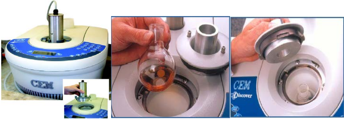
Şekil 1.46. Bir tek-mod mikrodalga cihazı
