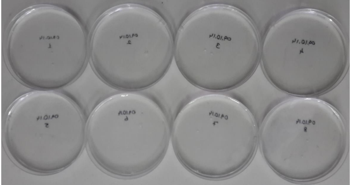
Şekil 4. Petri kaplarında %15'lik sodyum hidroksit ( NaOH ) çözeltisinde bekletilen otolitler (orijinal)
