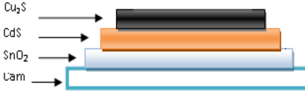
Şekil 12. İnce film polikristal yapılu CdS/Cu 2 S heterogeçit yapısı
