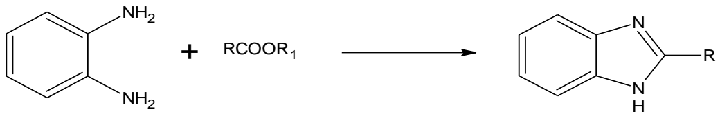
Şekil 29. Esterlerin 1,2-diaminobenzenin ile halka kapanması reaksiyonu
