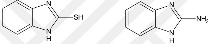
Şekil 51. Korozyon inhibitörleri: 2-merkaptobenzimidazol ve 2- aminobenzimidazol
