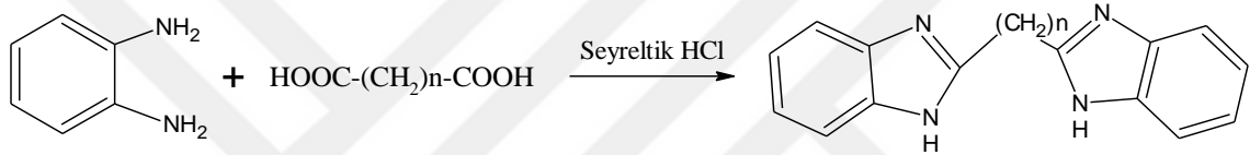
Şekil 26. Phillips yöntemi ile bisbenzimidazol sentezi
