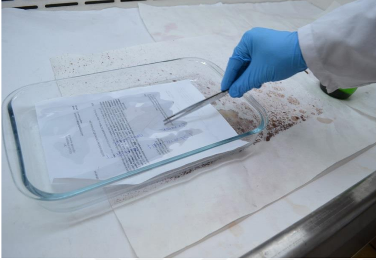
Şekil 14. Ninhidrin çözeltisinin çeker ocak içerisinde kâğıda uygulanması
