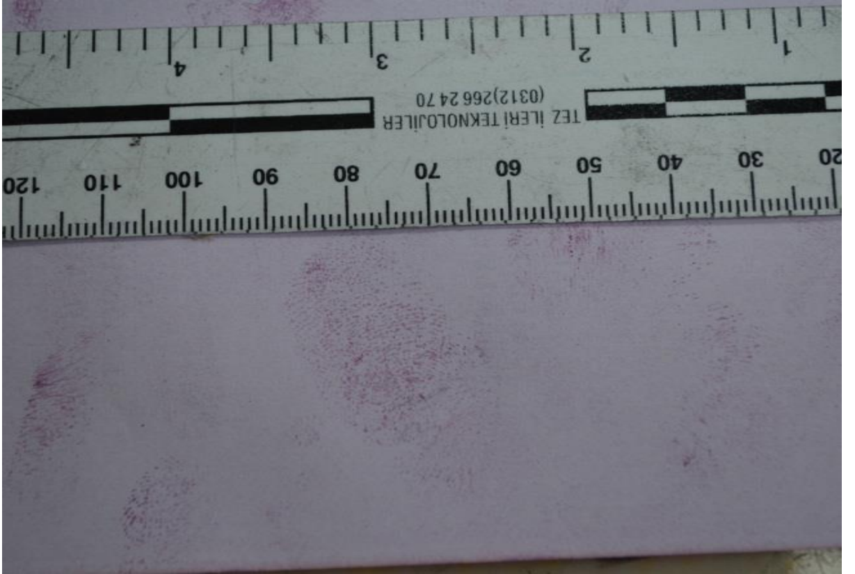
Şekil 15. Ninhidrin uygulaması sonucukâğıtta gelişen parmak izi
