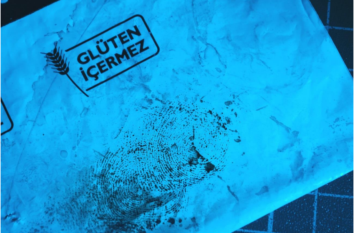
Şekil 24. ANT kimyasalı ile hazırlanan çözelti ile boyanan gözeneksiz yüzeyde 455 nm dalga boyunda görünen vücut izi
