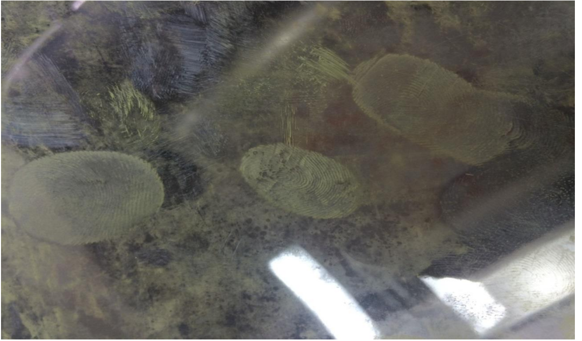
Şekil 26. ANT kimyasalı ile hazırlanan çözelti ile boyanan gözeneksiz yüzeyde gün ışığında görünen vücut izi
