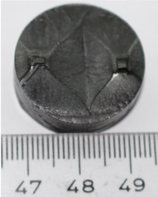
Şekil 42. Çoklu çekirdekli yapıdaki ( d = 14 mm) örneğin ısıl işlem sonrası görünümü.
