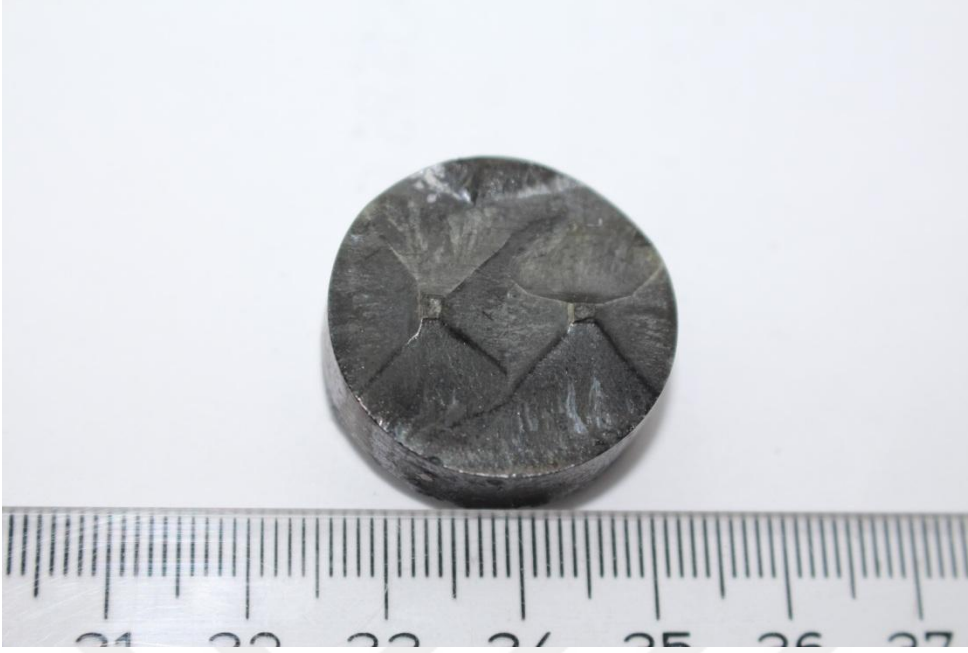
Şekil 45. Çoklu çekirdekli yapıdaki ( d=12 mm) örneğinin ısıtım sonrası üst yüzünün fotoğrafı.
