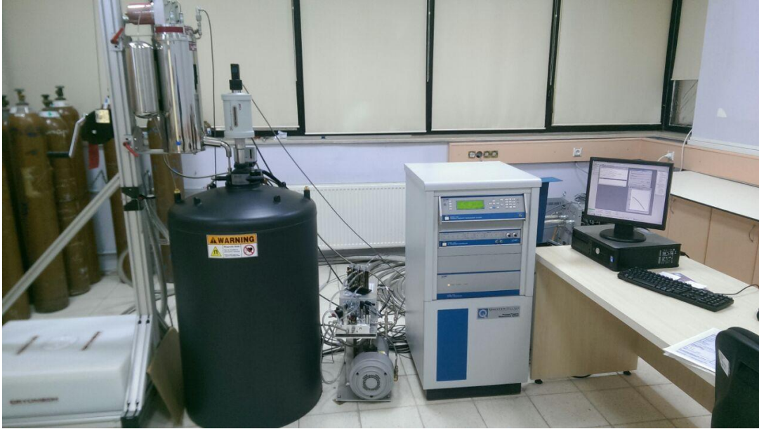
Şekil 51. Quantum Design PPMS sistemindeki titreşim örnekleme manyetometre VSM (vibrating sample magnetometer) modülü.
