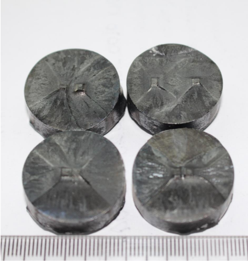
Şekil 46. Isıtım sonrası d=0, 1, 4 ve 12 mm uzaklığındaki çoklu kristal yapıdaki YBCO süperiletkenlerin üst yüzeylerinin fotoğrafları.
