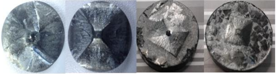
Şekil 32. YBCO süperiletken peletinin T_{max} değişimlerinin büyüme etkisinin şematik gösterimleri ve fotoğrafları.
