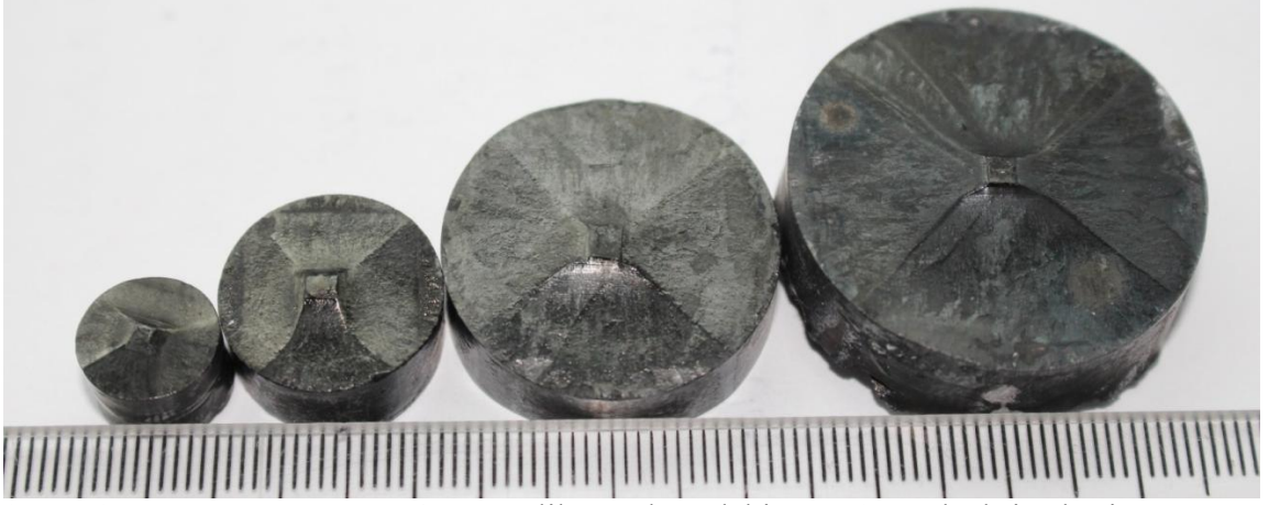
Şekil 37. 13, 20, 32 ve 40 mm'lik çaplarındaki YBCO tek kristallerin üstten karşılaştırılması.
