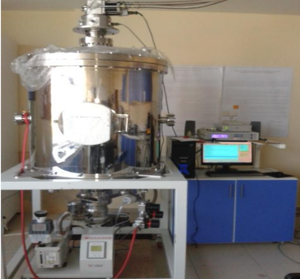
Şekil 50. Manyetik kaldırma kuvveti ölçüm sistemi.
