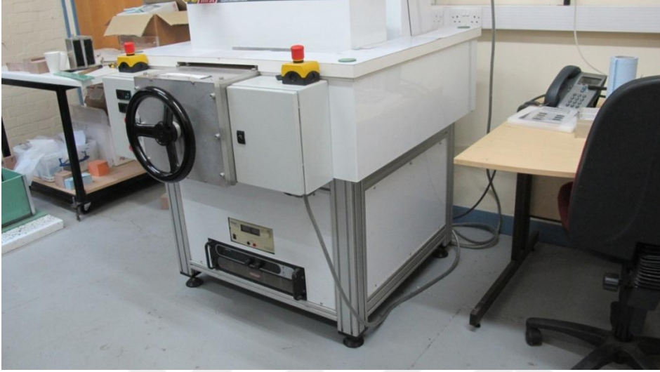
Şekil 52. Tuzaklanan alan ölçüm sistemi (Cambridge Üniversitesi).
