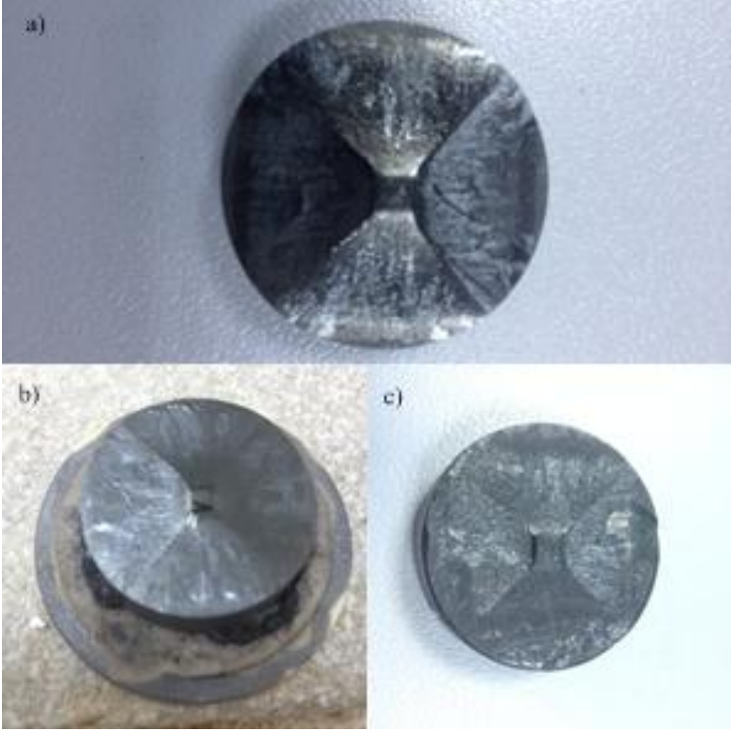
Şekil 35. a) 20 mm b) 32 mm ve c) 40 mm'lik YBCO tek kristal süperiletkenlerinin ısıtım işlem sonrası görüntüsü.
