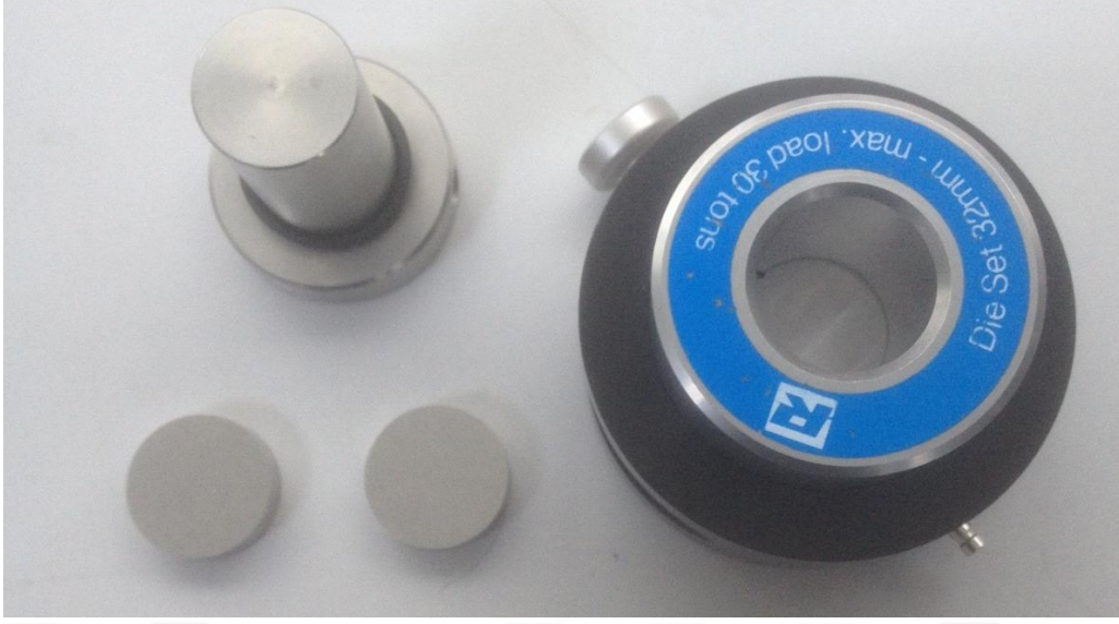
Şekil 25. Retsch marka 32 mm çapında presleme aygıtı.
