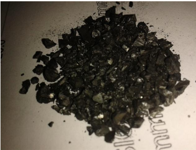
Şekil 22. \text{Nd}_{1.8}\text{Ba}_{2.4}\text{Cu}_{3.4}\text{O}_7 pelletinin kırılan parçaları (çekirdekler).
