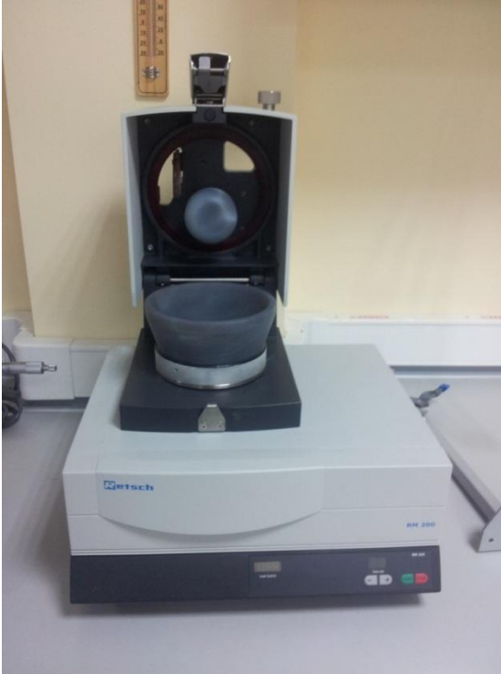
Şekil 16. Retsch marka RM200 model agat havanlı öğütücü.
