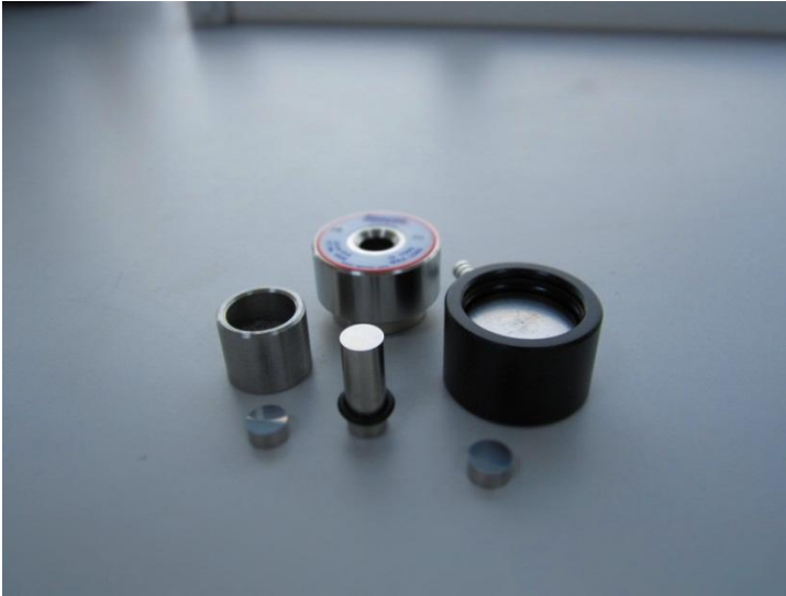
Şekil 18. Perkin-Elmer marka 13 mm çapında presleme aygıtı.
