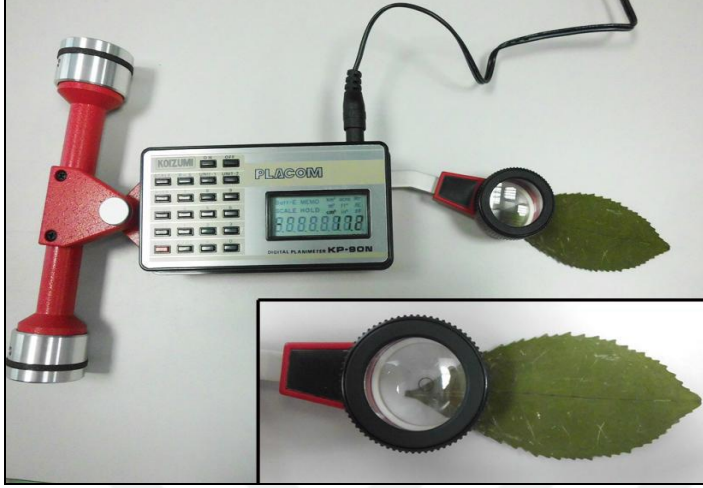
Şekil 12. Dijital planimetre ile yaprak alanının taranması.
