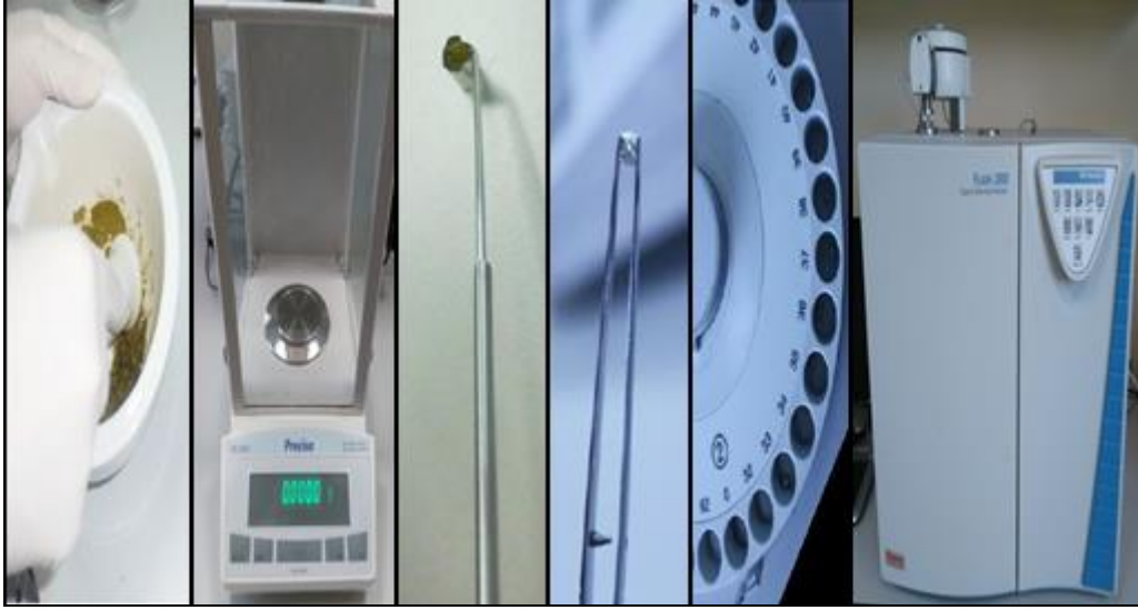
Şekil 13. Analiz öncesi hazırlık safhaları ve NCS Analyzer cihazı.
