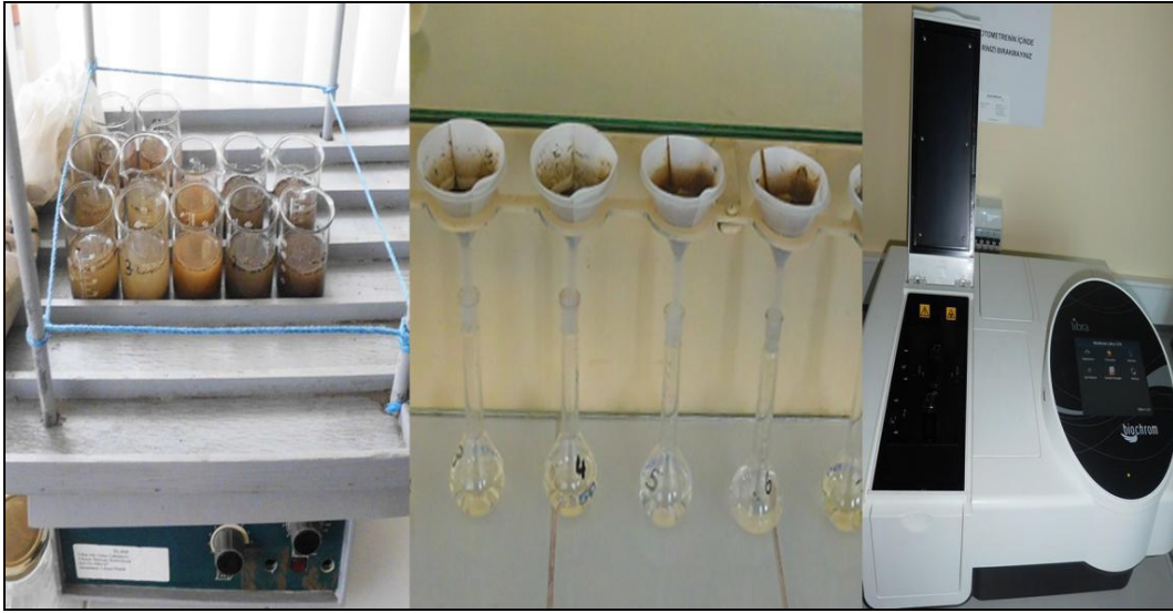
Şekil 15. Toprakta fosfor analizinin yapılması.
