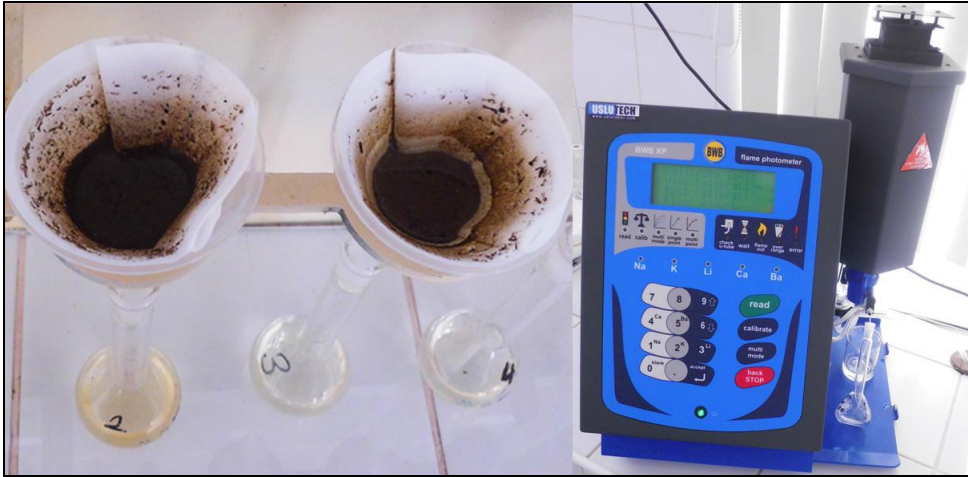
Şekil 16. Alev fotometre cihazında potasyum analizi.
