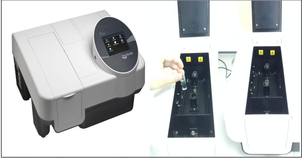
Şekil 9. Fosfor değerlerinin Biochrom Libra S70 Spektrofotometrede okutulması.
