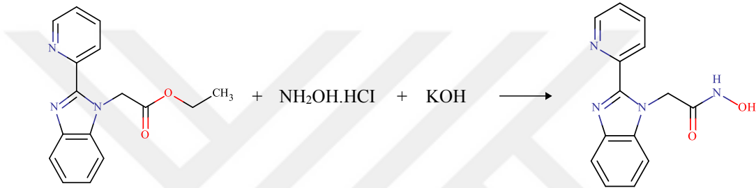
Şekil 26. 2-(2-piridin)benzimidazol-N-asetohidroksamik asit sentezi
