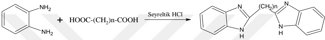
Şekil 35. Philips yöntemine göre bisbenzimidazol sentezi
