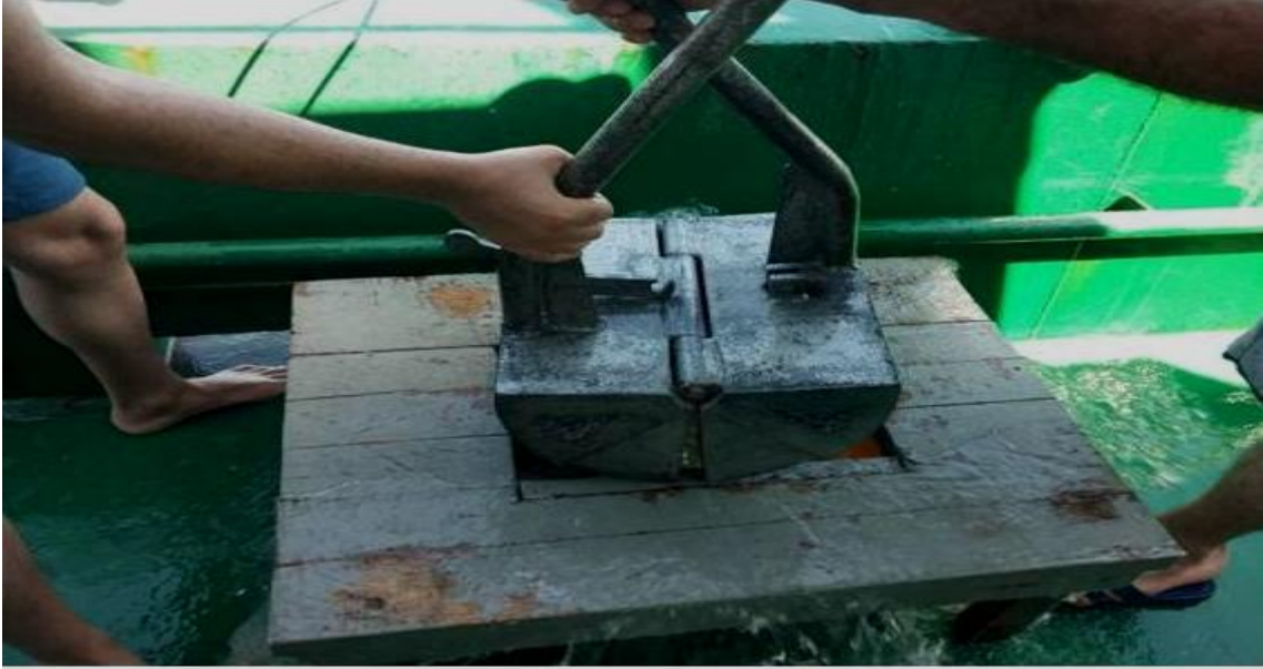
Şekil 17. Van-Ween grap kepçesi ile sediment örnekleme yapılırken.
