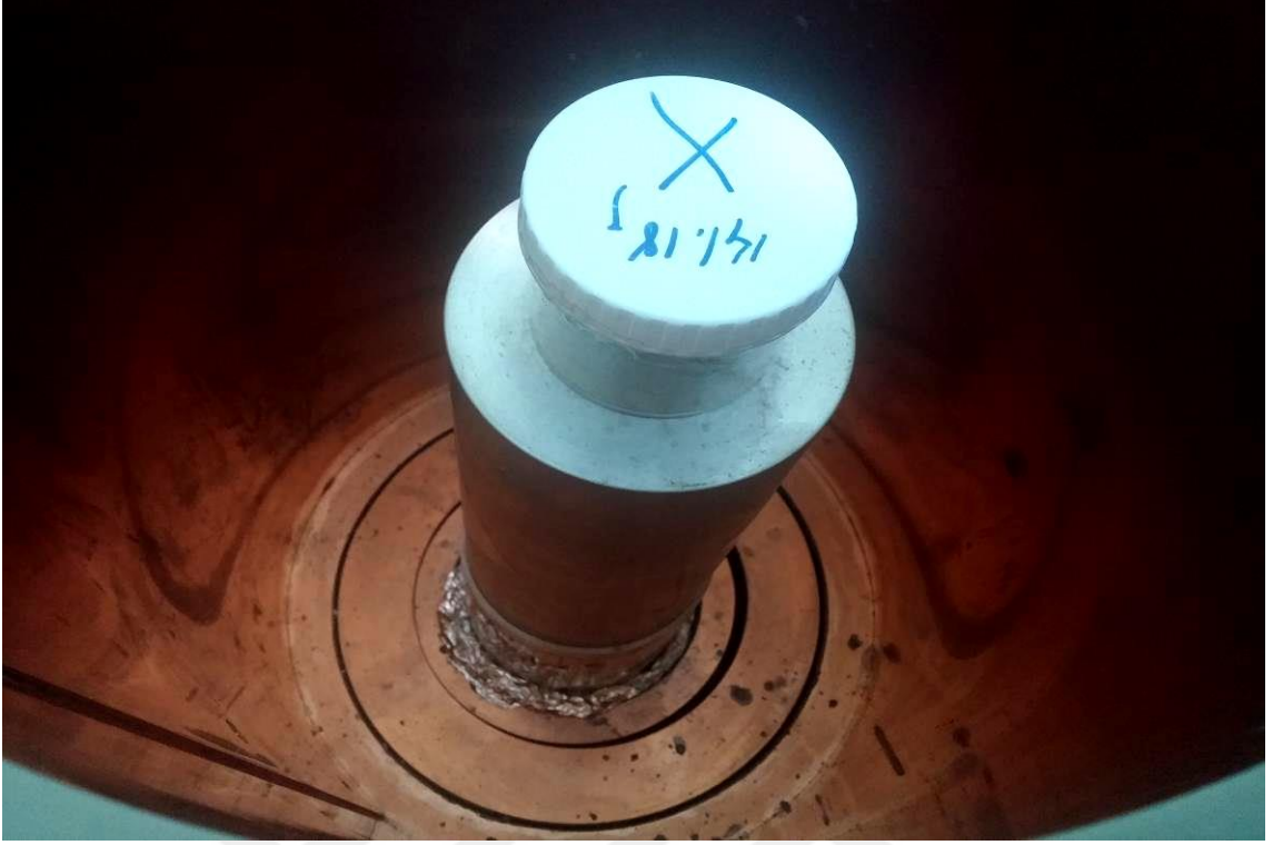
Şekil 25. Sediment örneğinin kurşun zırh içinde dedektörde ölçümü.
