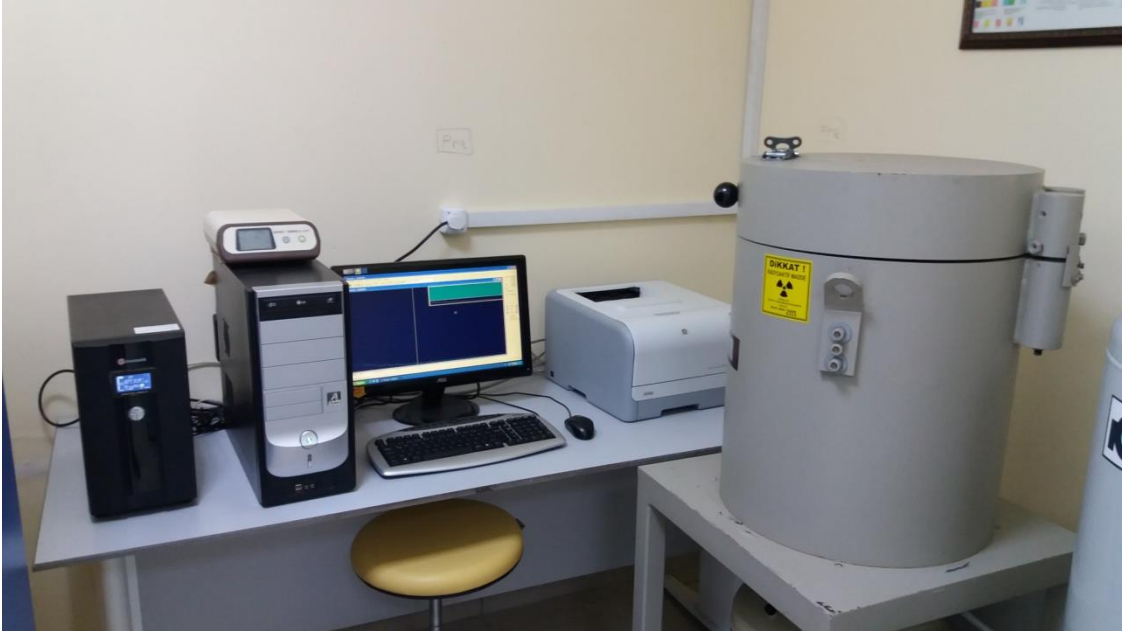
Şekil 20. Gama spektrometre sisteminin genel görünüşü.
