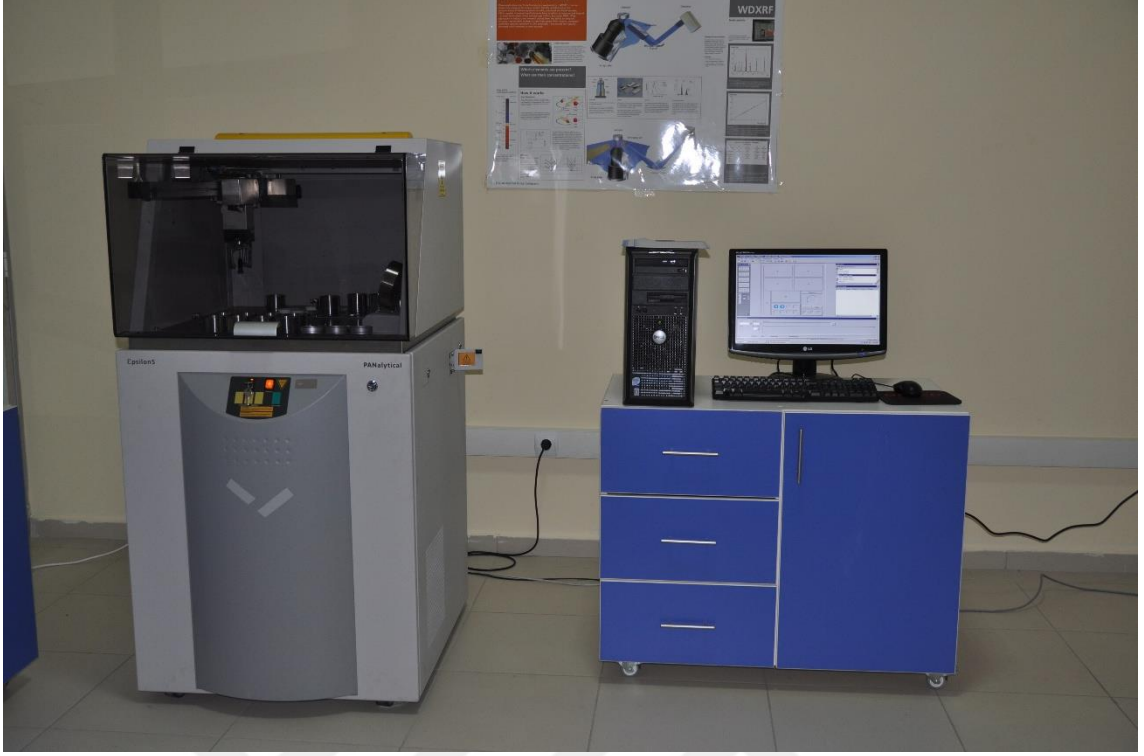
Şekil 15. EDXRF cihazı (Epsilon 5, PANalytical, Almelo, the Netherlands).
