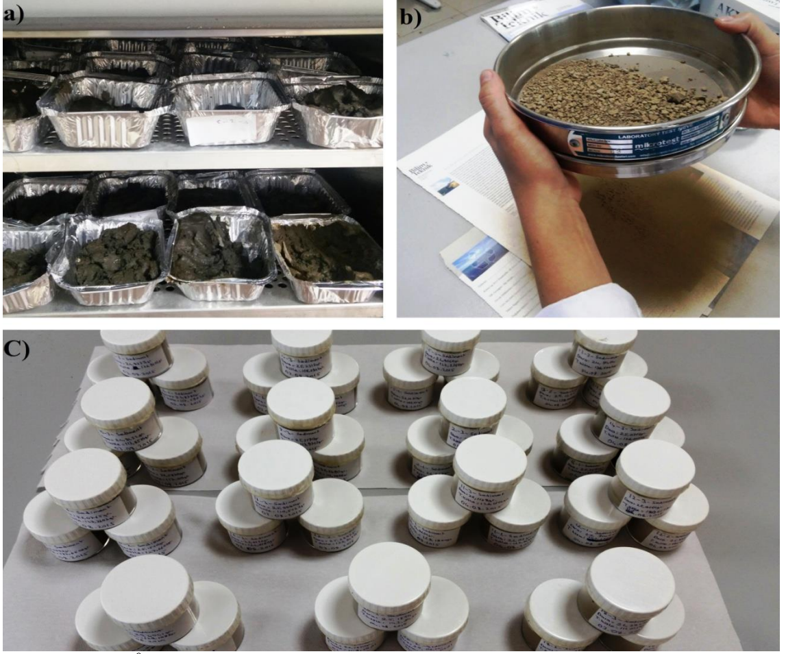
Şekil 18. a) 85 0 C’de etüvde kurutulan sediment örnekleri b) Elekten (37 µm) geçirilen sediment örnekleri c) 137 Cs radyoizotopu konsantrasyonlarını ölçmek için hazır hale getirilen sediment örnekleri.
