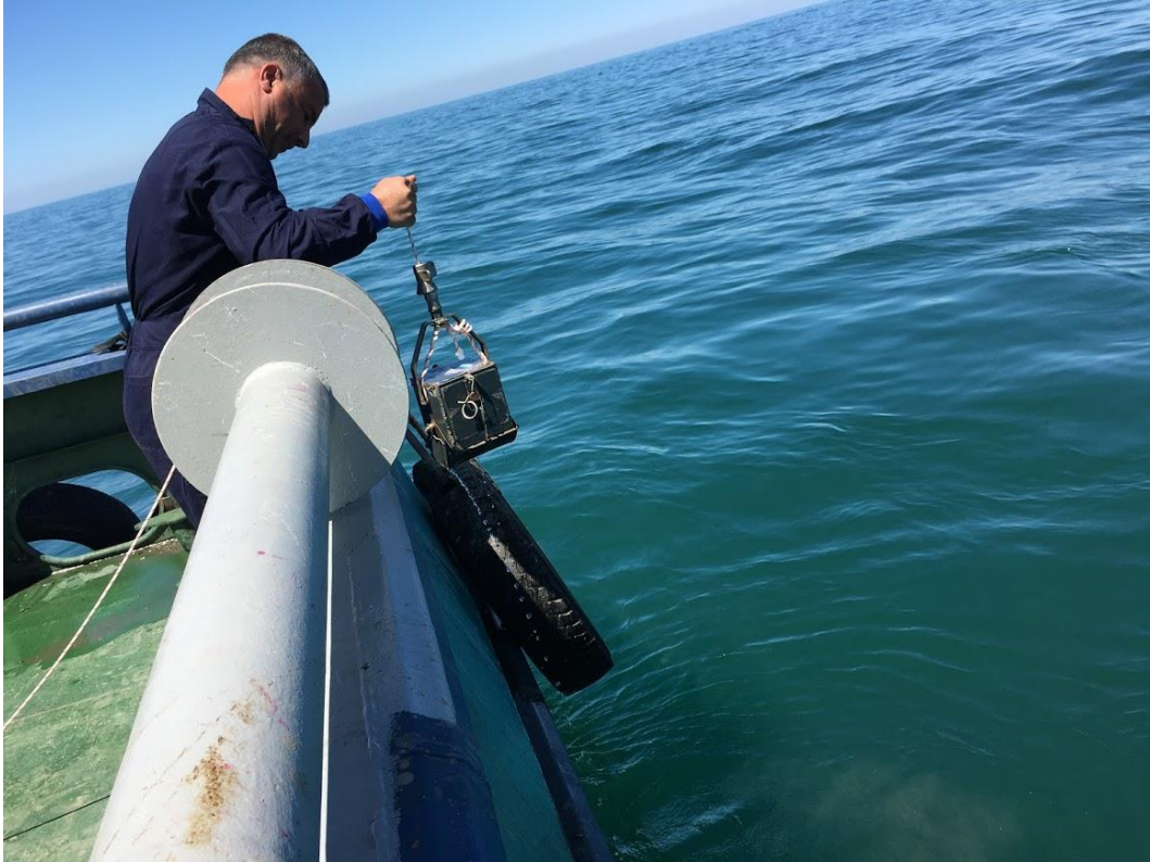
Şekil 3. Deniz ortamında Ekman Grab ile sediment örnekleme.
