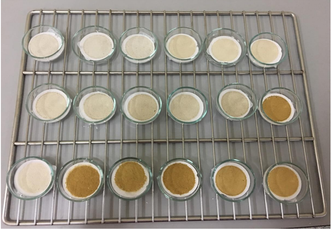
Şekil 5. POM örneklerinin cam petrilerle etüvde kurutulması.
